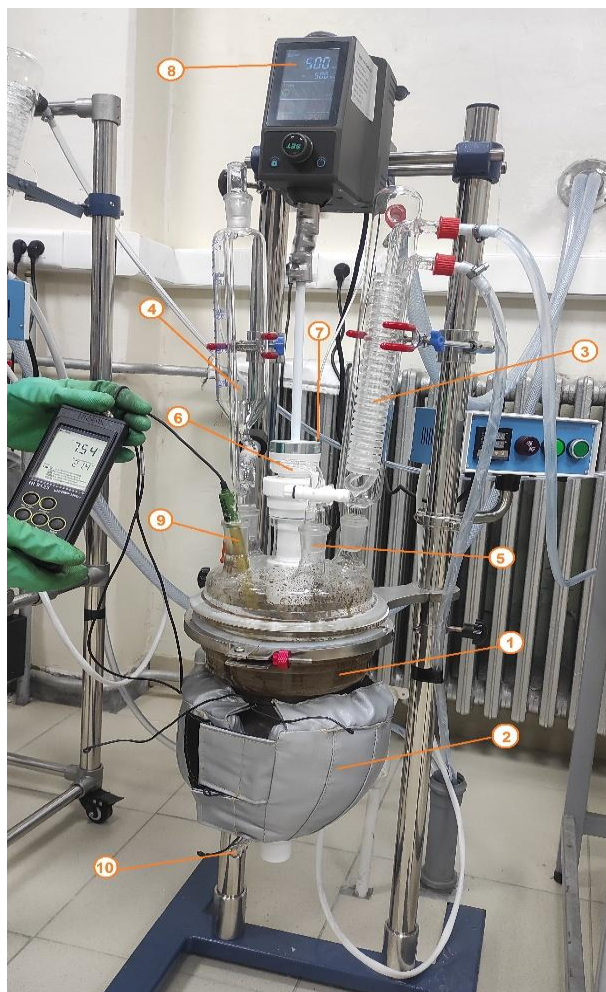
Slika 4.9. Aparatura za luženje: 1 - telo staklenog reaktora; 2 - električni grejači; 3 – kondenzator; 4 - posuda za šaržiranje tečne faze; 5 - otvor za šaržiranje čvrste faze; 6 – mešalica; 7 – termopar; 8 - automatska kontrola temperature i broja obrtaja; 9 - otvor za elektrodu za merenje pH; 10 - otvor za dešaržiranje
