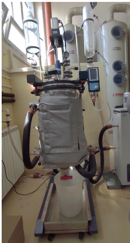
Slika 4.10. Šaržni reaktor zapremine 50L (za prvu fazu luženja - predtretman većih količina EAF prašine)
