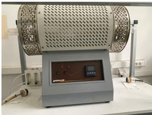
Слика 2.1.1.1: Protherm electrical tube furnace (PTF 16/38/250), protherm furnaces, ergazi mah., 1819. sokak./1695.
