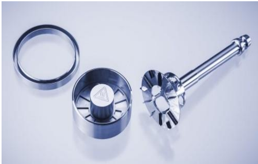
Slika 3.7. Merna ćelija za smicanje (levo) i merni sistem PSC43-21-0 (desno) (preuzeto iz Introduction in powder rheology , 2023)
