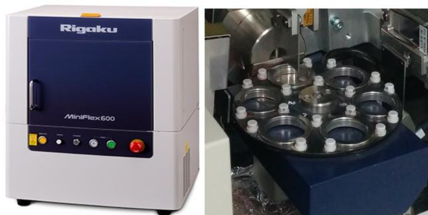
Слика 54. Rigaku Mini Flex 600 (лево) и Autosampler за 6 узорак (десно)
