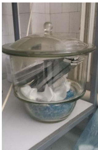
Слика 50. Чување контролних узорака у лабораторијски условима
