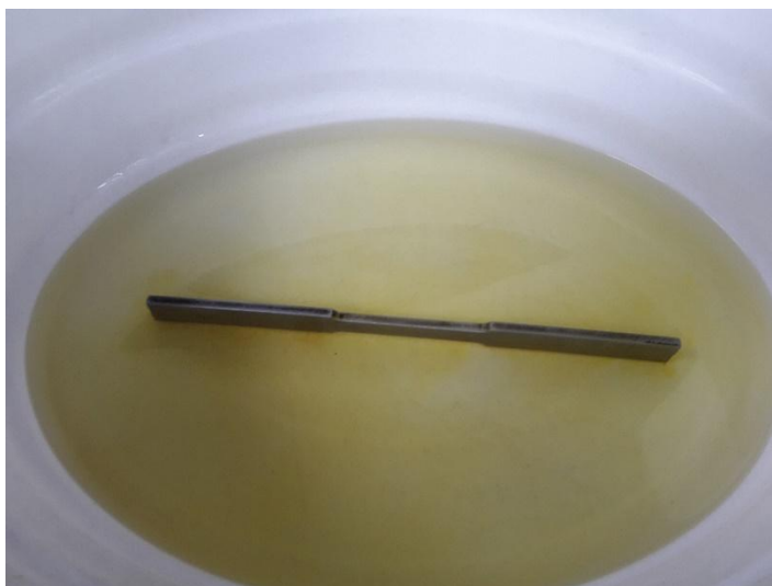
Слика 51. Уклањање продуката корозије са епрувета према стандардом дефинисаним условима
