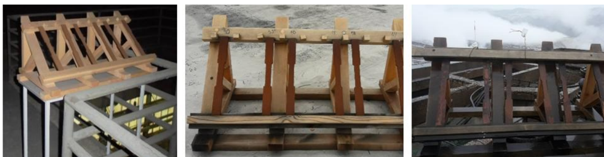
Слика 37. Изглед излаганих узорака на дан завршетка експеримента, пре скидања за чишћење
