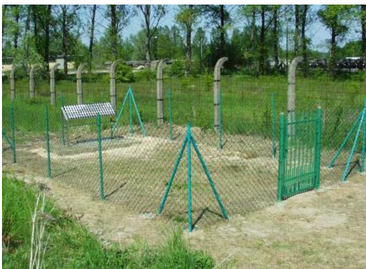
Слика 36. Корозионе станице за испитивање атмосферске корозије у близини Варшаве [80]
