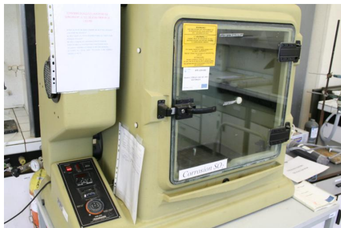
Слика 41. Апаратура за извођење Кестерниковог теста (извор www.materialnova.be )
