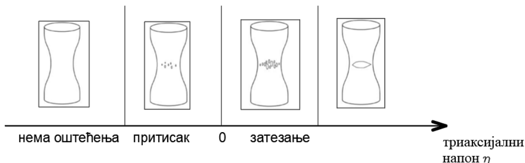
Слика 11. Промена триаксијалног напона са порастом запремине шупљина код дуктилног лома
