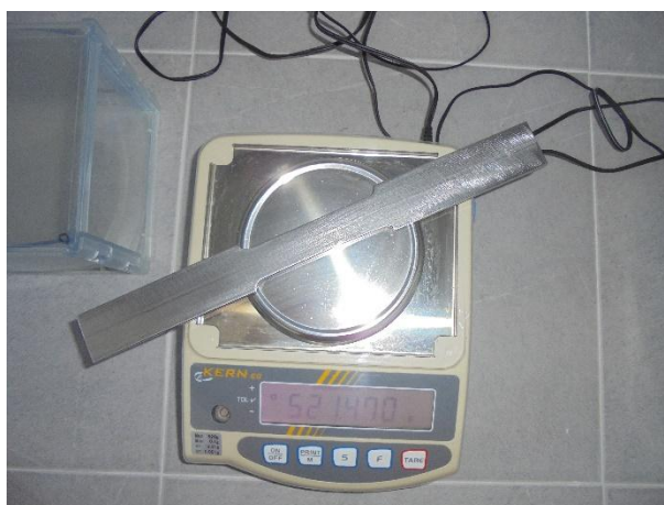
Слика 43. Мерење епрувета пре излагања корозији
