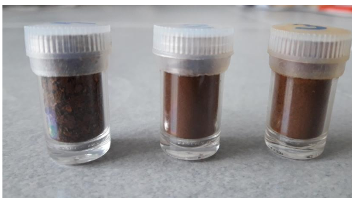
Слика 53. Изглед продуката корозије припремљених за XRD анализу
