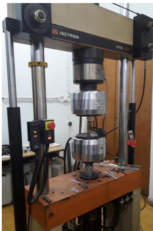
Слика 52. Кидалица са хидрауличким погоном на којој је извршен експеримент
