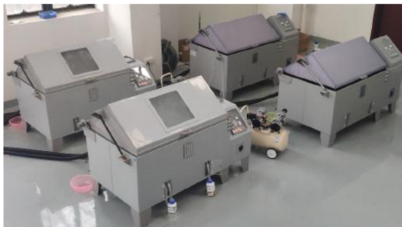
Слика 40. LYW-075N комора за убрзано старење, тест неутрални сланим спрејем [9]
