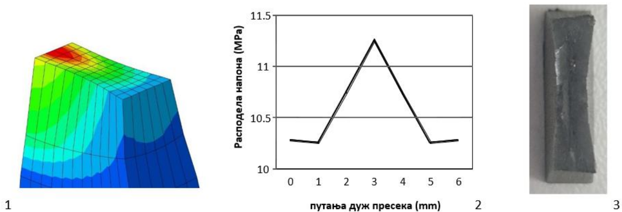
Слика 94. Запремински удео шупљина у попречном пресеку узорка у сланој комори: (1) на почетку пукотине; (2) крива расподеле напона дуж путање од слободне површине до слободне површине кроз попречни пресек узорка; (3) слика попречног пресека узорка након прелома
