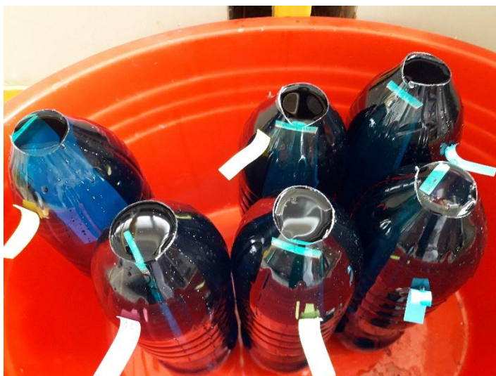
Слика 45. Испитивање епрувета континуалним потапењем у раствор електролита
