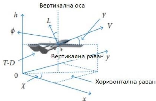
Слика 1: Беспилотна летелица у троосном координатном систему
