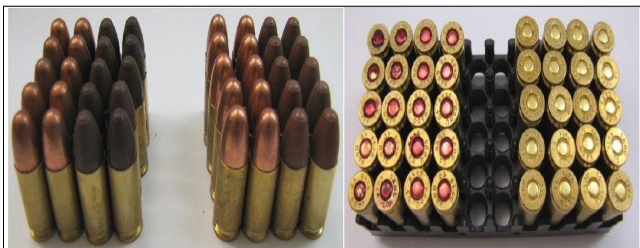
Слика 5.8. Четири калибра муниције са два различита пројектила и прајмера (Rotariu et al., 2015).
