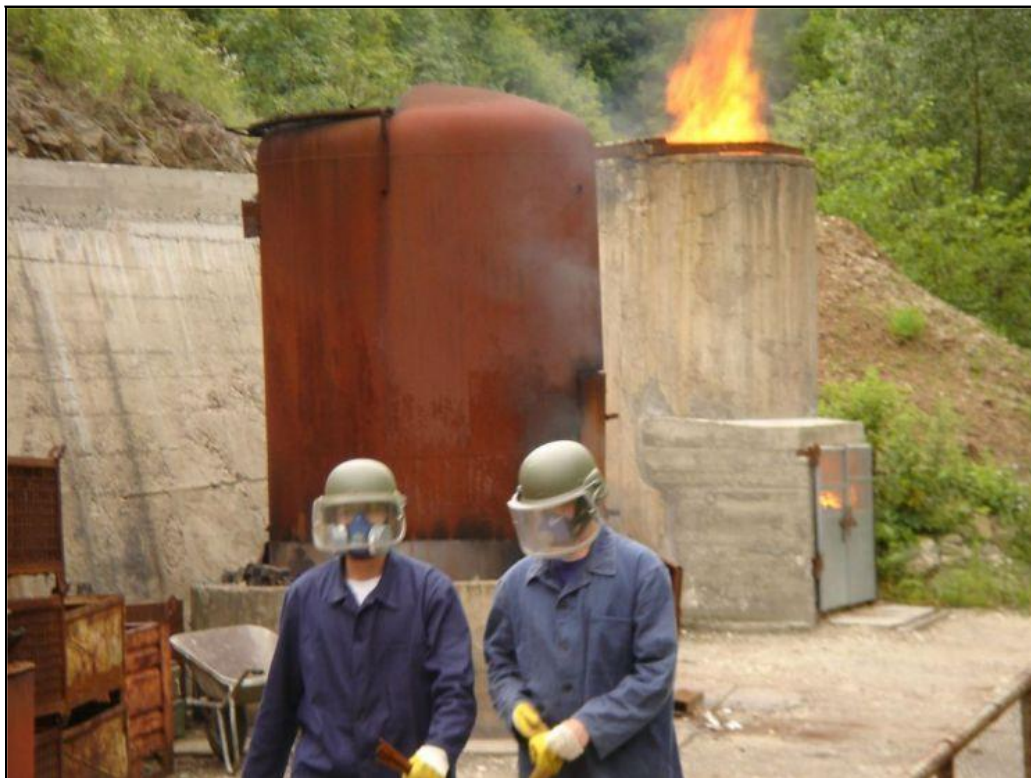
Слика 6.4. Спаљивање елемената убојних средстава у кацама (Milosavljević, 2012)
