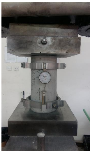
Слика 78. Одређивање модула еластичности
