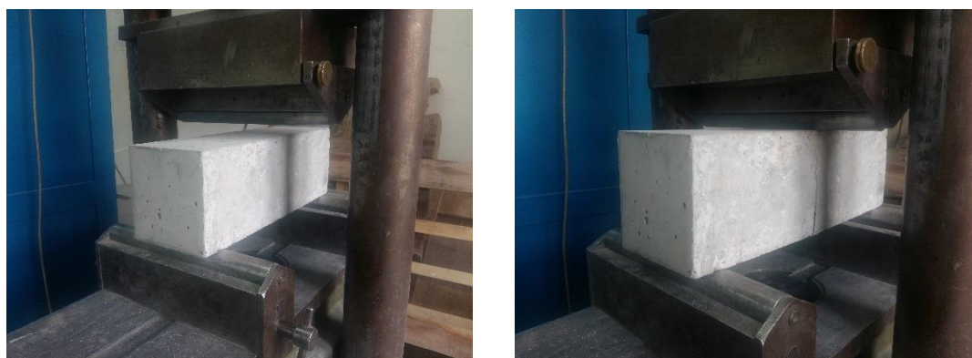
Слика 72. Испитивање чврстоће при затезању савијањем
