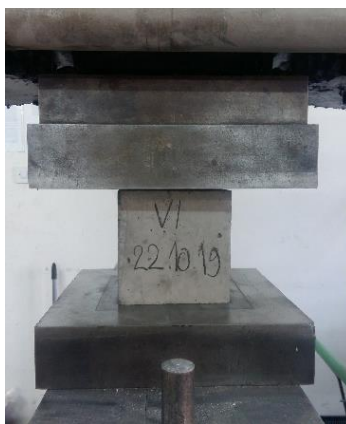
Слика 65. Одређивање чврстоће при притиску
