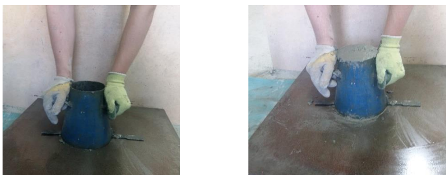
Слика 55. Испитивање конзистенције свеже бетонске мешавине
