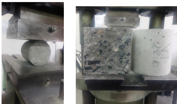
Слика 75. Испитивање чврстоће при затезању цепањем
