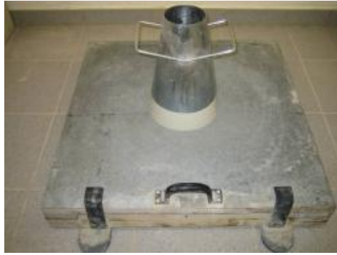
Слика 56. Метода слегања ( Slump Method ) [120]
