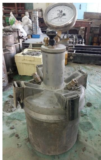
Слика 61. Апаратура за мерење увученог ваздуха [42,122]
