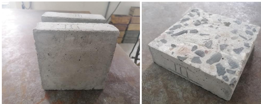
Слика 85. Плочасти узорак исечен из коцке
