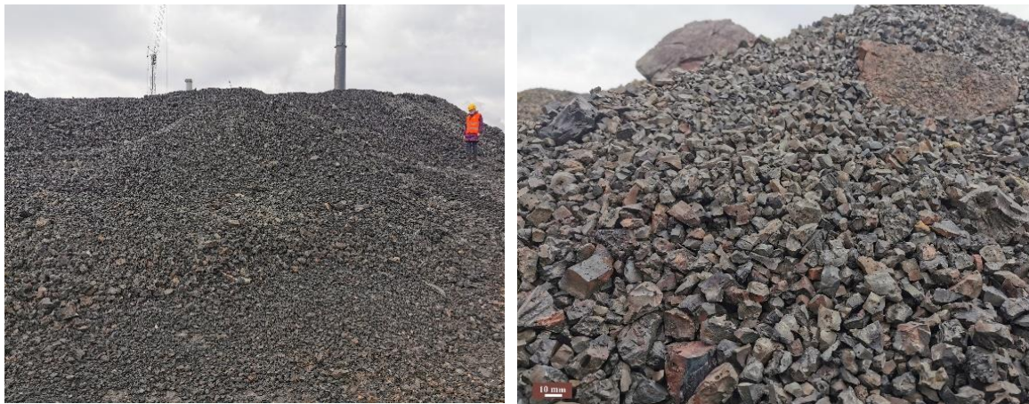
Слика 44. (а) Депонија агрегата од бакарне шљаке у непосредној близини прерађивачких капацитета Рударско топионичарског басена у Бору; (б) макроскопски изглед агрегата CSA на депонији
