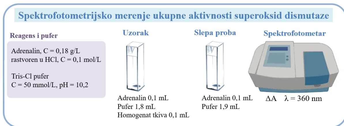
Slika 10. Spektrofotometrijsko merenje ukupne aktivnosti superoksid dismutaze.
