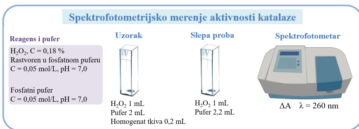
Slika 9. Spektrofotometrijsko merenje aktivnosti katalaze.
