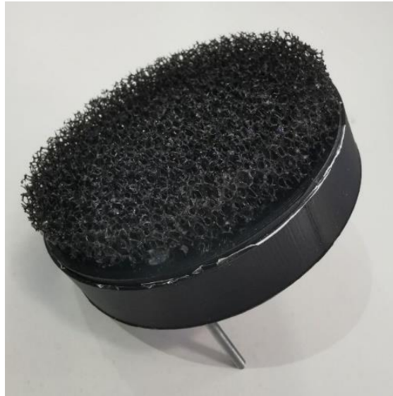
Слика 11 Реализовани микрофонски модул са ЕМИ кућиштем и заштитом од ветра ( wind shield )
