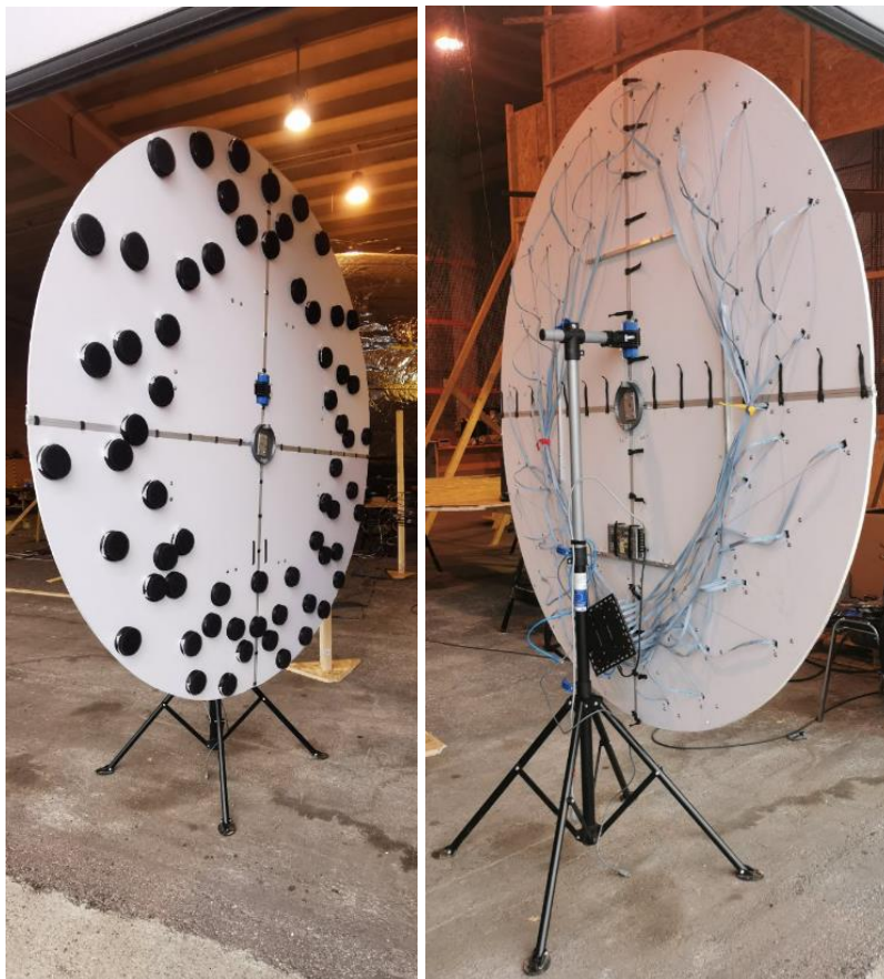
Слика 12 Реализовани тест модел акустичког сензора
