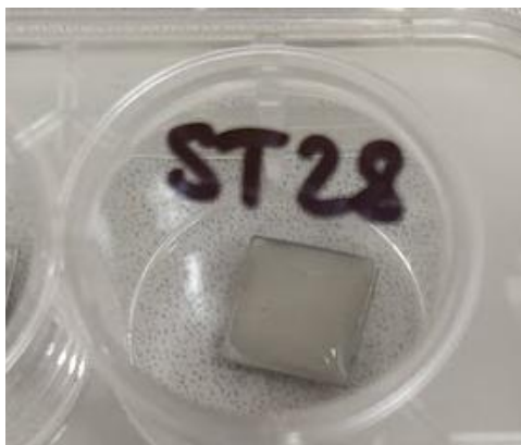
Slika 4.6. Prikaz površine kupona nerđajućeg čelika inokulisane suspenzijom izolata Salmonella Typhimurium ST28 u količini od 100 \mu l.
