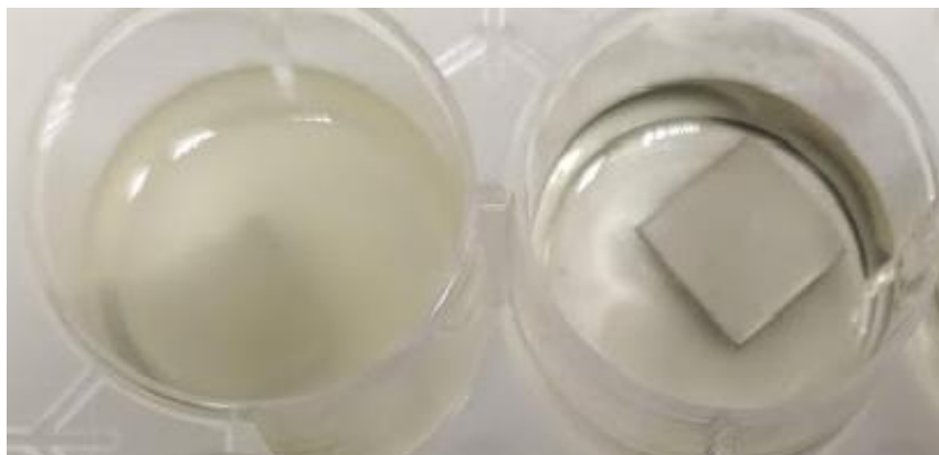
Slika 4.7. Prikaz kupona nerđajućeg čelika u Luria Bertani bujonu nakon inkubacije (levo – sa inokulisanim izolatom Salmonella Typhimurium ST28; desno – samo Luria Bertani bujon).
