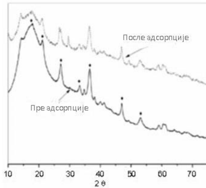
Слика 11. XRD анализа ER/DETA/FO/FD адсорбента пре и после адсорпције
