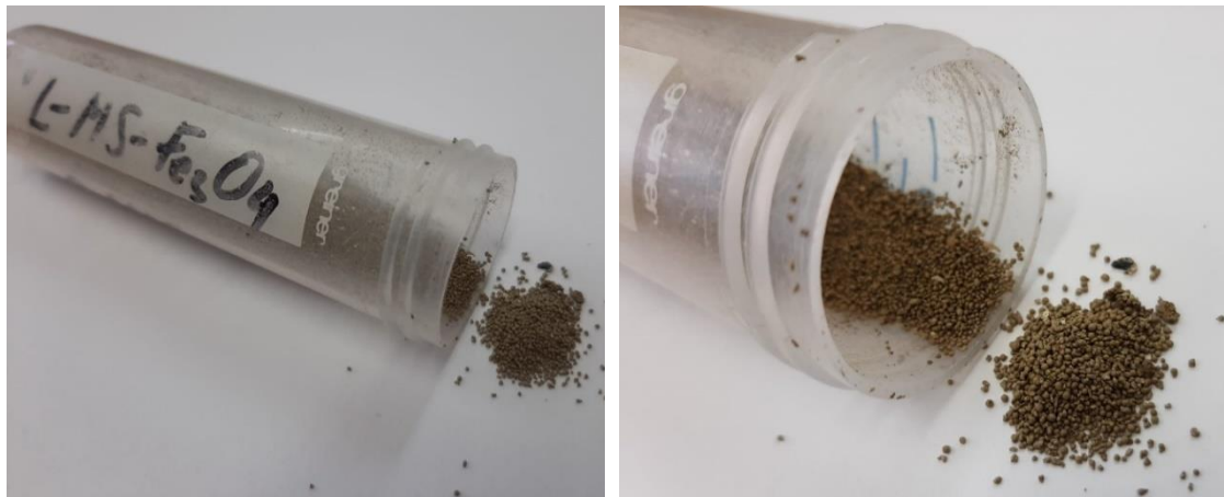
Слика 20. Изглед адсорбента A-LMS Fe 3 O 4
