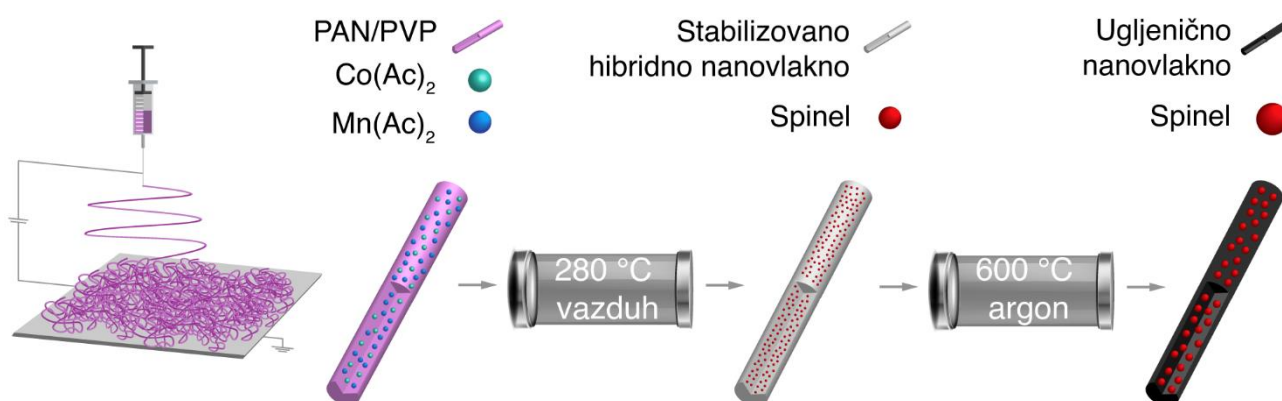
Slika 3.2. Dobijanje ugljenično–spinelnih kompozitnih vlakana prikazano kroz opisane etape procesiranja.
