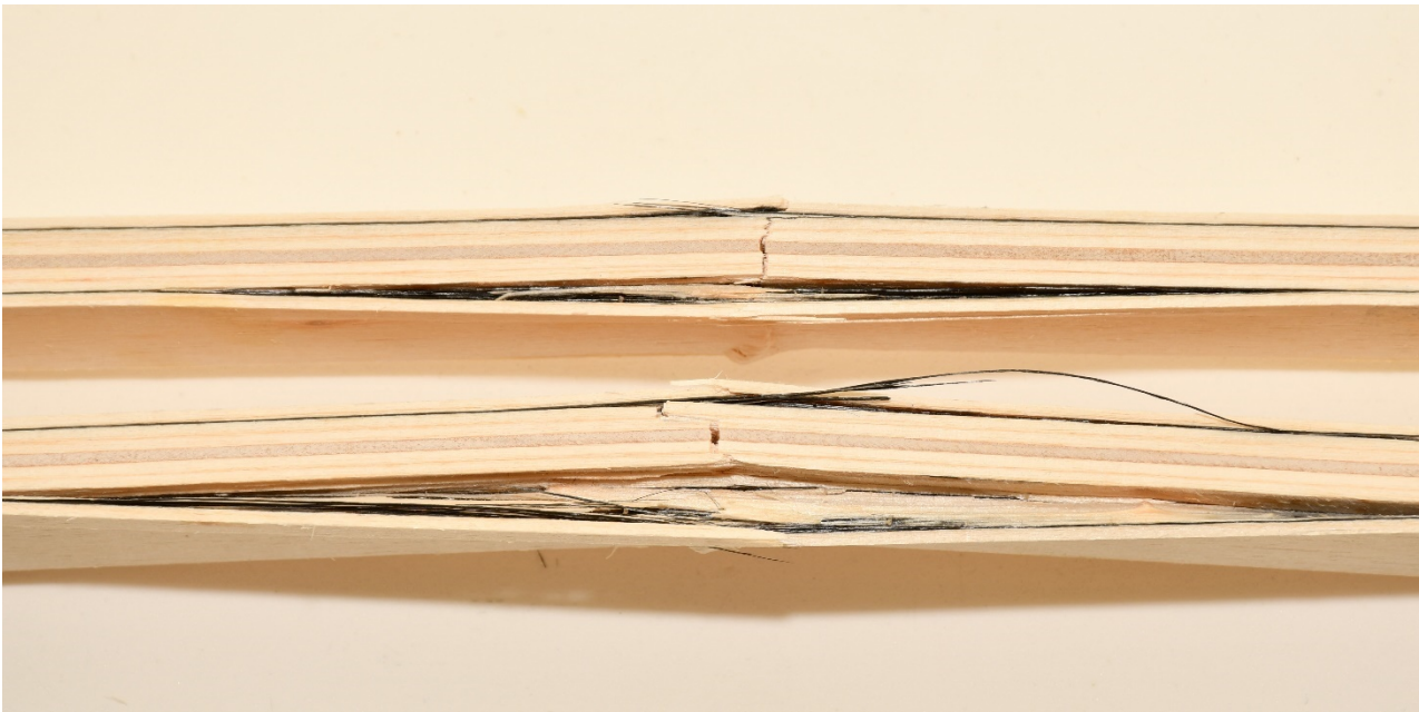
Слика 111. Лом фурнира по супстрату код узорака ЕК1ОР2-СЕ3 и ЕК1ОР3-СЕС
