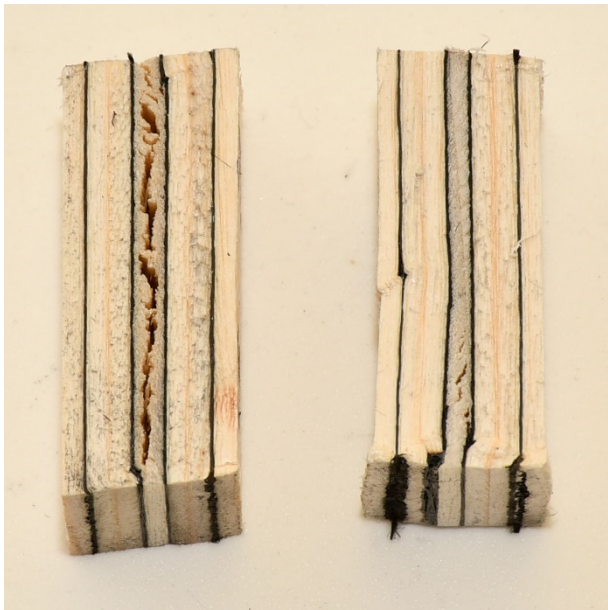
Слика 142. Лом епрувета из плоча ЕК2 по средњем фурнирском листу
