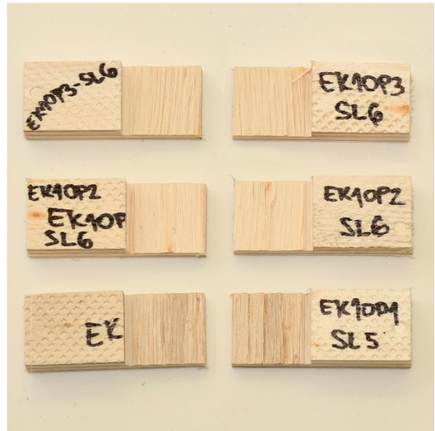
Слика 89. ЕК1 типски облик лома епрувета – ТИП1
