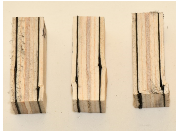
Слика 145. Деламинација у слоју FRP-FRP при испитивању притисне чврстоће паралелно влакнима епрувета из плоча ЕК3
