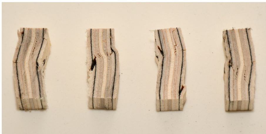
Слика 148. Испитивање притисне чврстоће управно на влакна – карактеристичан лом епрувета из плоча ЕК1
