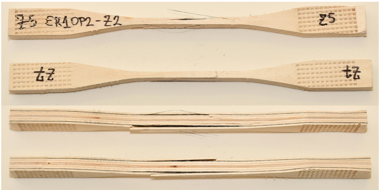
Слика 153. Испитивање затезне чврстоће паралелно влакнима – карактеристичан лом епрувета из плоче ЕК1
