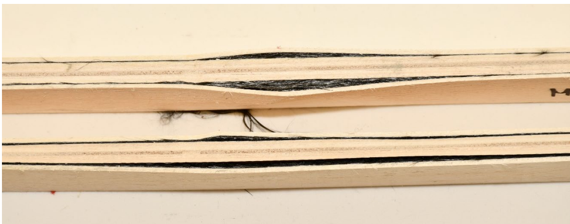
Слика 123. Дeламинација у слоју FRP-FRP у епруветама из плоче МК3 након извршеног тестирања
