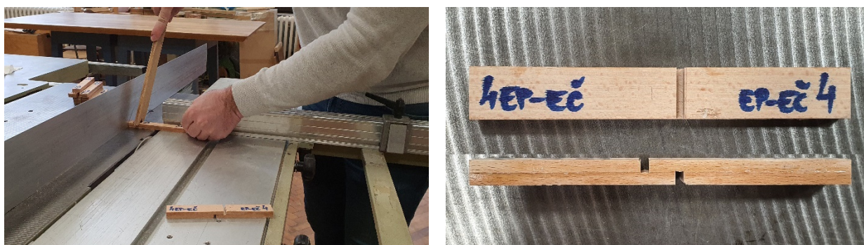
Слика 51. Процес зарезивања епрувета и формирање смичуће равни
