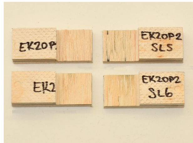
Слика 93. ЕК2 лом по средишњем листу фурнира – ТИП 1
