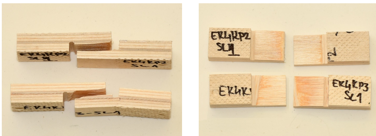
Слика 100. EK4 лом у трећем слоју фурнира ТИП3
