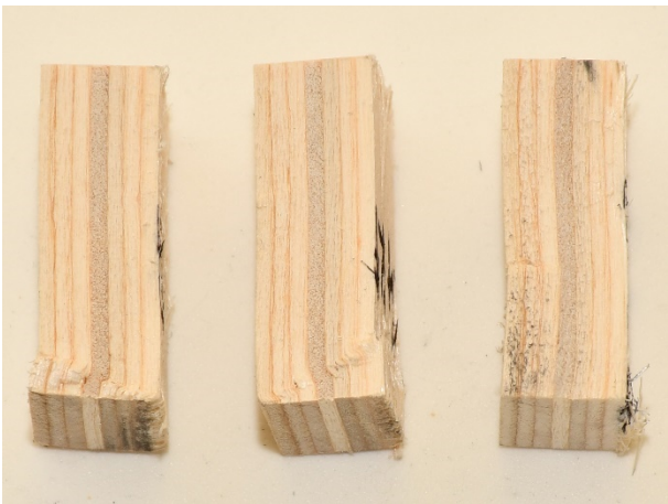
Слика 146. Испитивање притисне чврстоће паралелно влакнима – карактеристичан лом епрувета из плоча ЕК4: а) епрувете са избочавањем, б) епрувете са избочавањем и пуцањем влакана средишњих слојева фурнира
