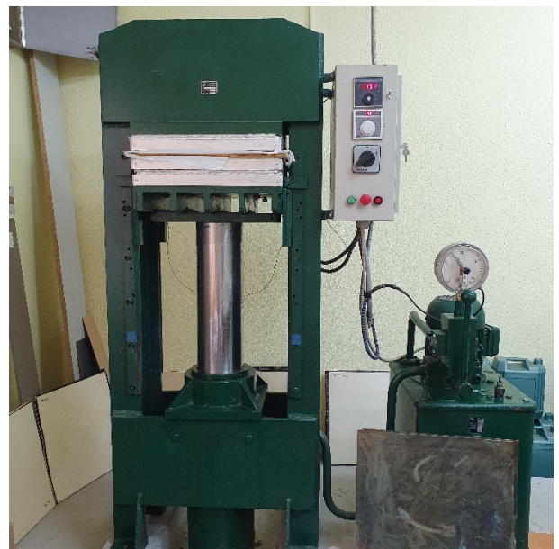
Слика 67. Пресовање плоче
