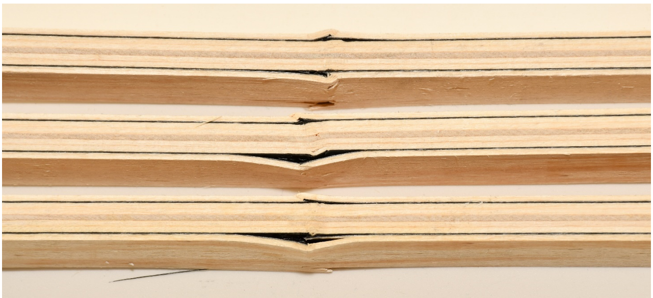
Слика 118. Оштећења епрувета ЕК3 у притисној зони, гњечење влакана и раслојавање у слоју FRP-FRP
