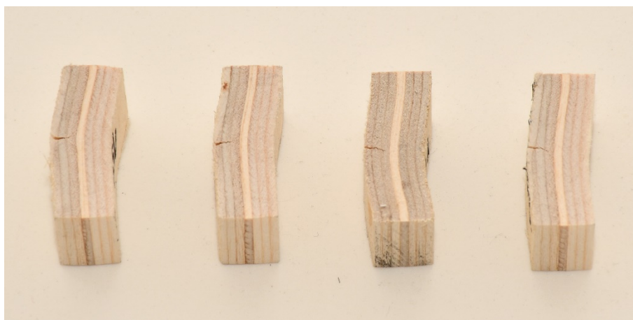
Слика 151. Испитивање притисне чврстоће управно на влакна – карактеристичан лом епрувета из плоча ЕК4
