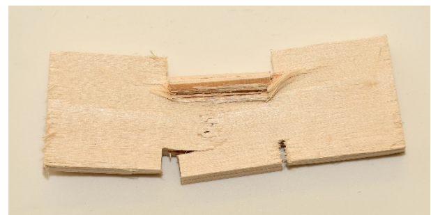
Слика 137. Испитивање чврстоће на смицање управно на раван плоче – прекорачење напона притиска при испитивању епрувета из плоча ЕК4КР1- S_{\perp 1}
