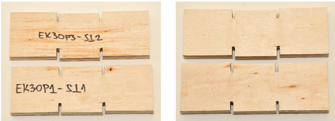
Слика 134. Испитивање чврстоће на смицање управно на раван плоче – карактеристичан лом епрувета из плоча ЕК3
