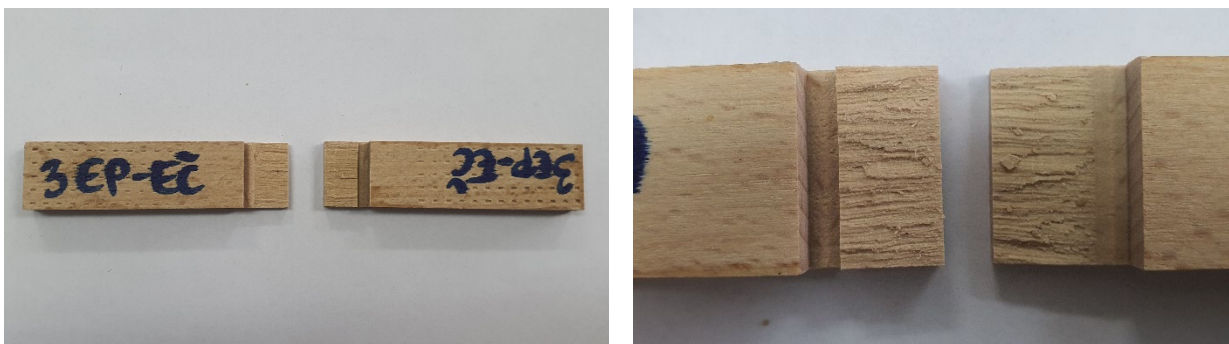
Слика 53. Типичан лом дрвених епрувета по супстрату у испитивању смицајне чврстоће у слоју лепка
