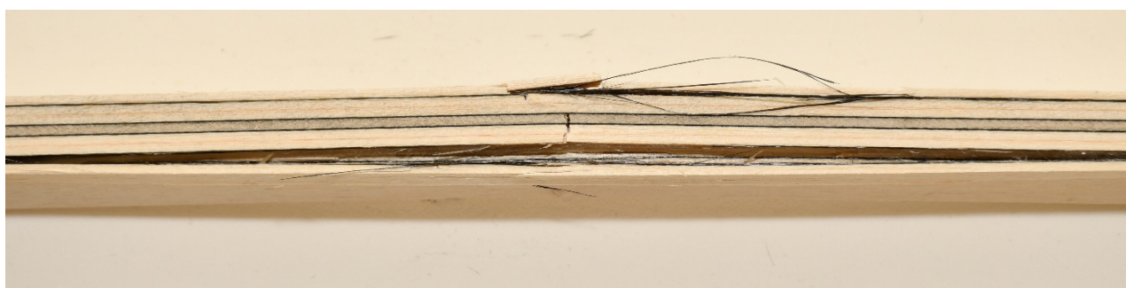
Слика 114. Оштећења епрувете ЕК2ОР1-СЕ3 приликом испитивања савојне чврстоће у равни плоче, цепање другог фурнирског листа
