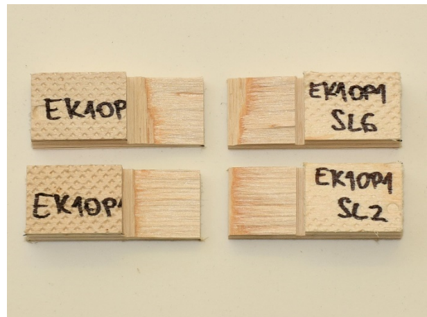
Слика 91. ЕК1 лом по трећем листу фурнира – ТИП3
