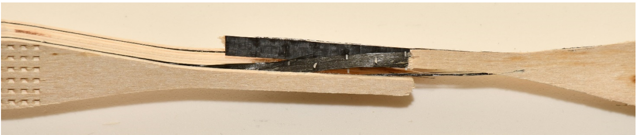
Слика 159. Деламинација у слоју FRP-FRP и FRP - дрво
