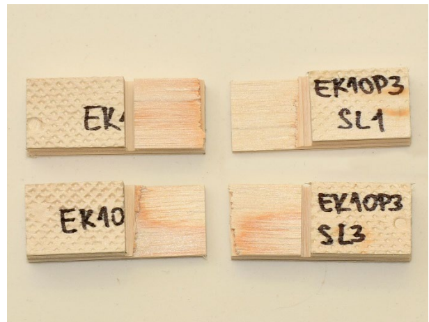
Слика 90. ЕК1 лом по другом листу фурнира – ТИП 2
