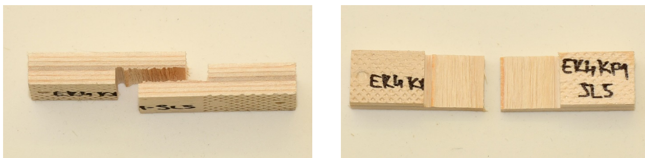
Слика 99. EK4 лом у средишњем слоју ТИП 1
