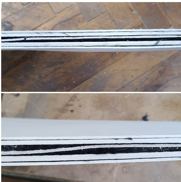
Слика 75. Раслојавање плоче са MUF адхезивом након сечења
