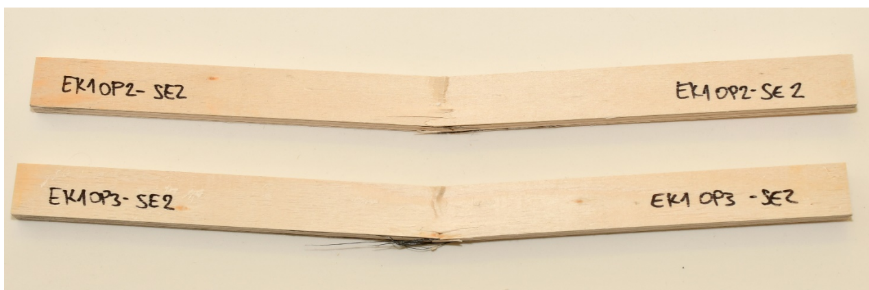
Слика 109. ЕК1 типски лом носача на савијање у равни плоче (лом влакана у затегнутој зони)
