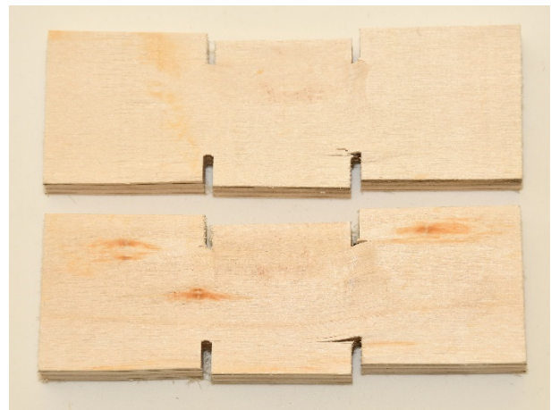
Слика 128. Испитивање чврстоће на смицање управно на раван плоче – карактеристичан лом за епрувете из плоча ЕК1
