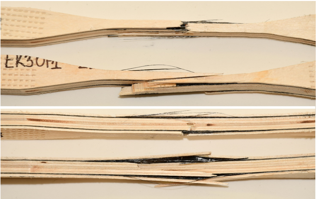
Слика 158. Испитивање затезне чврстоће паралелно влакнима – карактеристичан лом епрувета из плоча ЕК3
