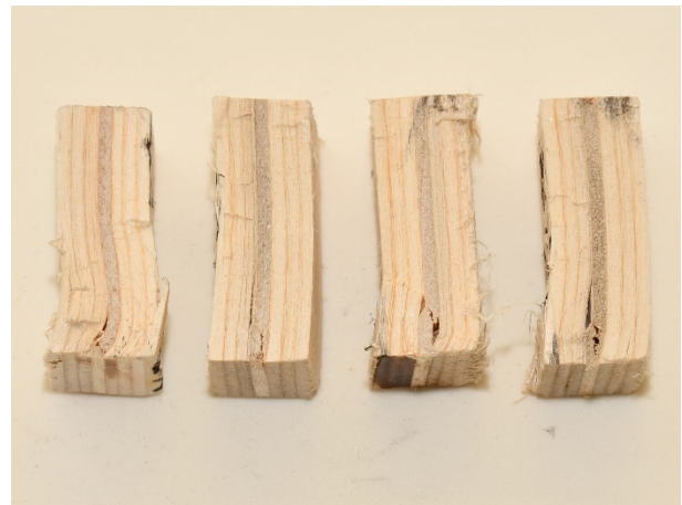
Слика 146. Испитивање притисне чврстоће паралелно влакнима – карактеристичан лом епрувета из плоча ЕК4: а) епрувете са избочавањем, б) епрувете са избочавањем и пуцањем влакана средишњих слојева фурнира
