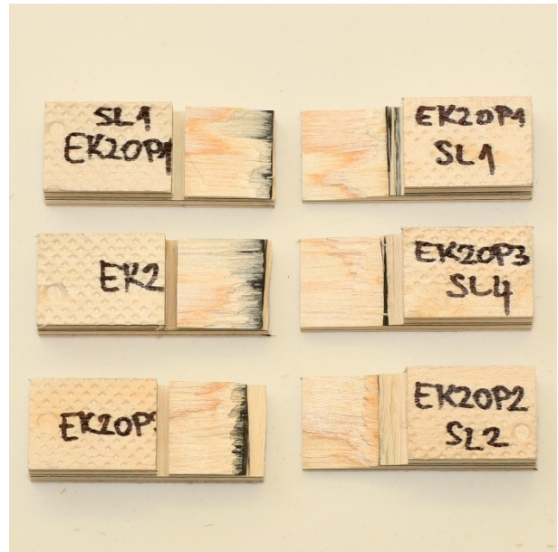
Слика 95. EK2 лом по више листова фурнира – ТИП 4
