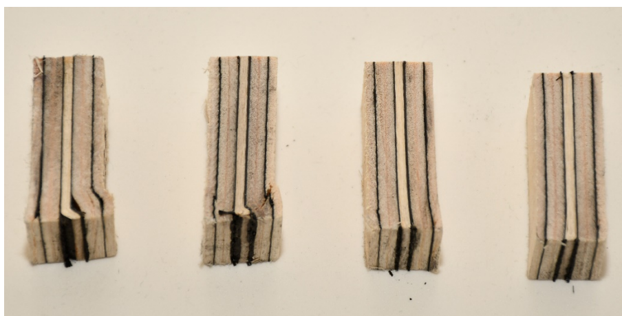
Слика 149. Испитивање притисне чврстоће управно на влакна – карактеристичан лом епрувета из плоча ЕК2
