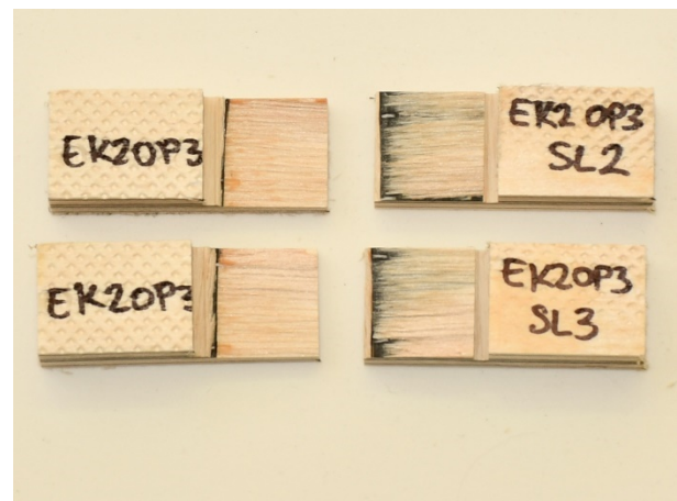
Слика 94. ЕК2 лом по трећем листу фурнира – ТИП 3
