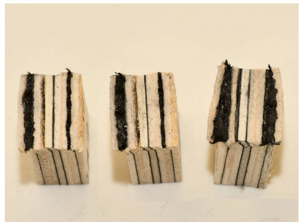
Слика 141. Испитивање притисне чврстоће паралелно влакнима – карактеристичан лом епрувета из плоча ЕК2
