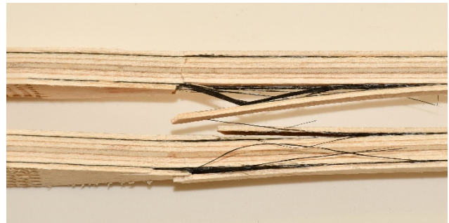
Слика 155. Детаљ лома у радијусу закривљена
