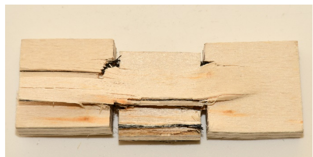
Слика 129. Апсолутни лом за епрувете из плоча EK1OP1-S13 при испитивању чврстоће на смицање
