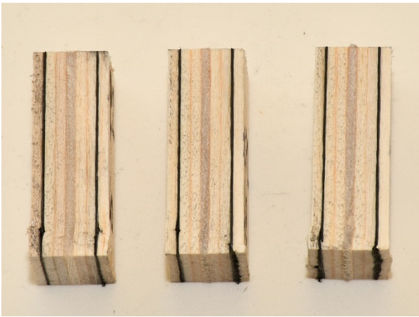
Слика 144. Испитивање притисне чврстоће паралелно влакнима – карактеристичан лом епрувета из плоча ЕК3
