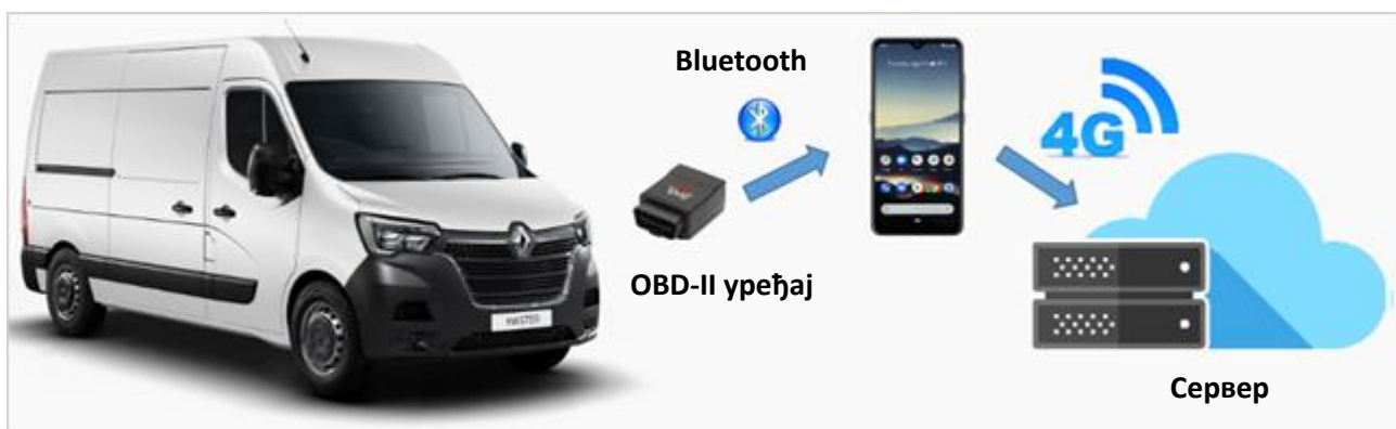
Слика 2. Архитектура система за прикупљање параметара вожње
