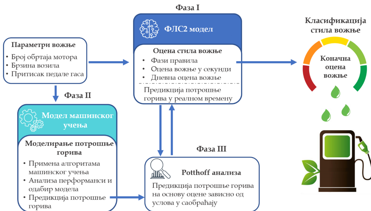
Слика 37. Архитектура интегрисаног модела за класификацију и предвиђање понашања возача
