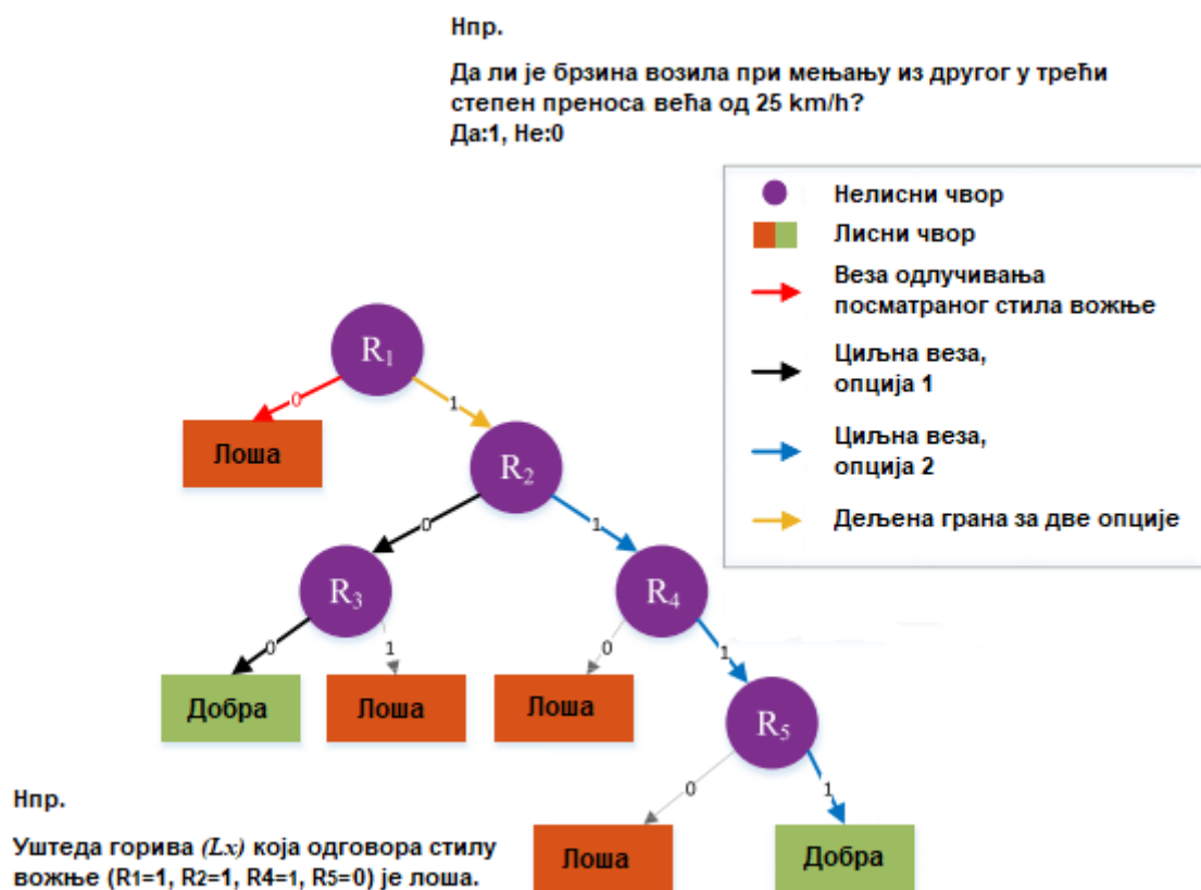
Слика 30. Модел вредновања стила вожње заснован на алгоритму стабла одлучивања [168]
