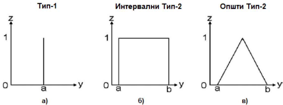
Слика 35. Секундарне функције припадности а) фази скупа типа 1, б) интервалног фази скупа типа 2, в) општег фази скупа типа 2 [191]
