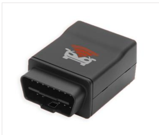
Слика 1. FLEETOMATIC уређај за читавање података путем OBD-II прикључка
