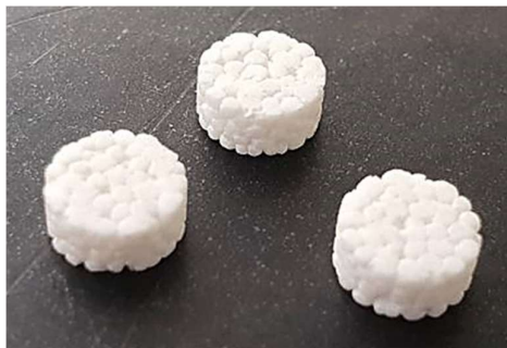
Slika 8. Izgled kompakata izrađenih od uzoraka P-serije (prečnik 6 mm)
