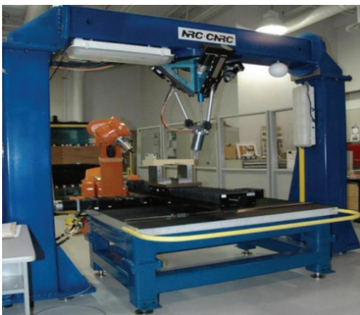
Слика 2.11 Реконфигурабилне машине алатке засноване на троосном паралелном механизму са транслаторним осама (Преузето и дорађено - [27,28])
