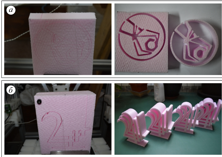
Слика Сп.6 Танкозидни делови израђени на машини алатки MOMA-W 4S: а)Лого центра за нове технологије катедре за производно машинство Машинског факултета у београду - процес израде и израђену делови; б)Лого Јупитер конференције - процес израде и израђену делови
