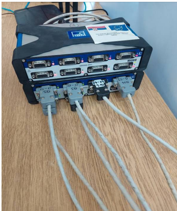
Слика 7.27. Повезивање сензора на мерно појачало
