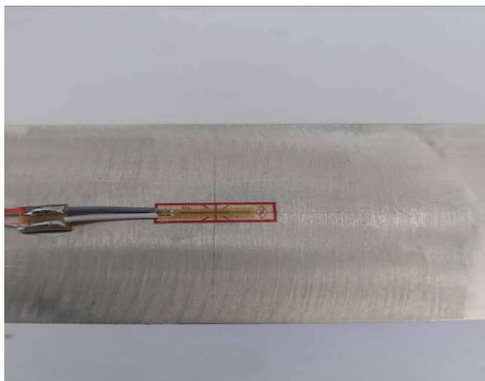
Слика 7.20. Постављена мерна трака
