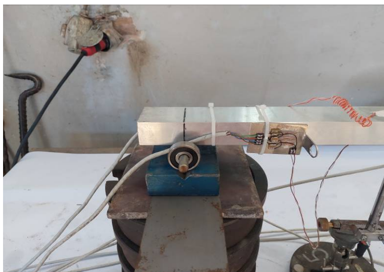
Слика 7.24. Ослоначки пресек на левом крају греде, омогућено само ротирање пресека
