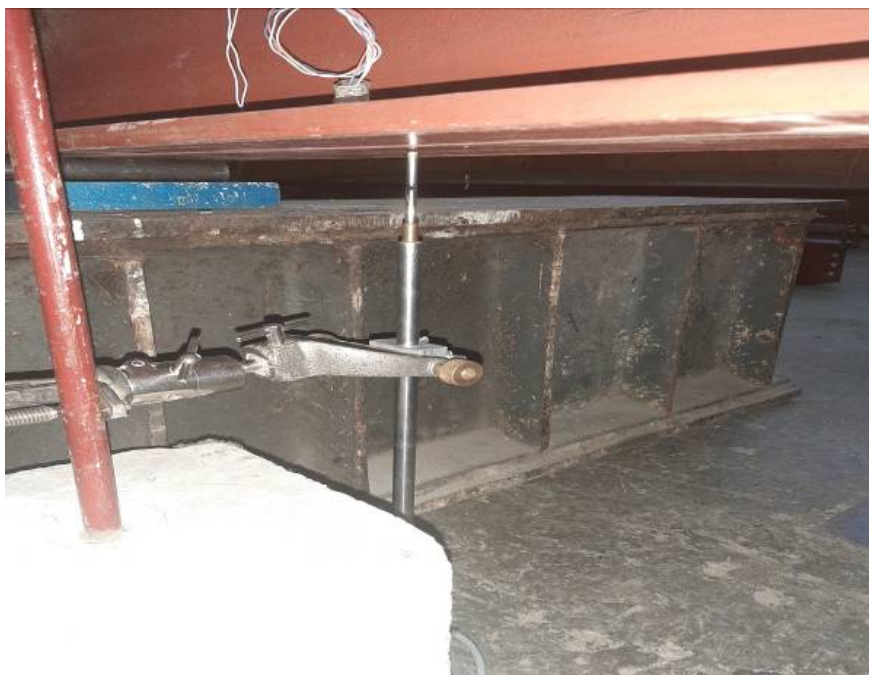
Слика 4.5. Угибомер WA 100 НВМ за директно мерење померања
