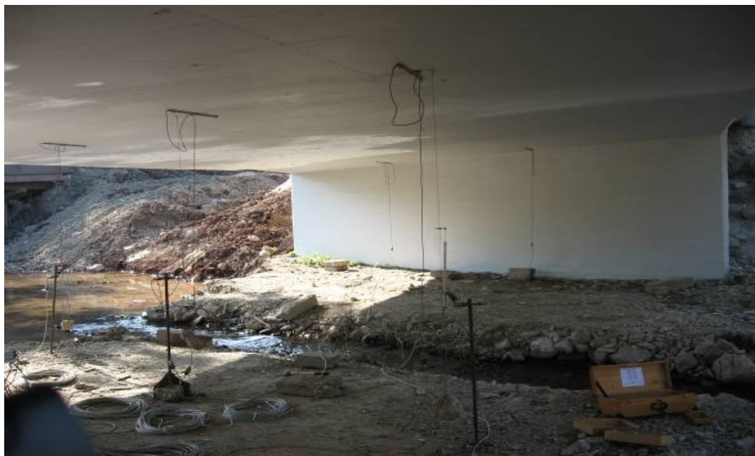
Слика 1.12. Постављање угиба, неопходан контакт са структуром (помоћу инварске жице) и чврста подлога испод разматране структуре
