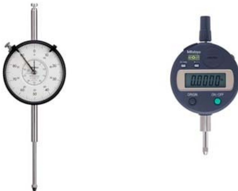
Слика 1.9. Механички угибомери-компаратери са градуисаном скалом и дигиталним читавањем
