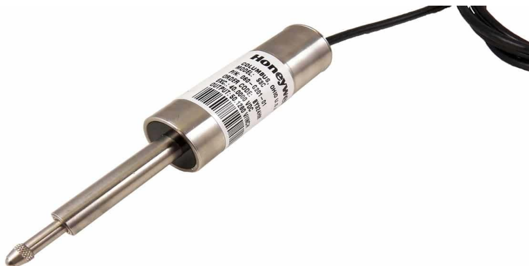
Слика 1.10. Индуктивни угибомери за које је потребно мерно појачало за вршење читавања вредности
