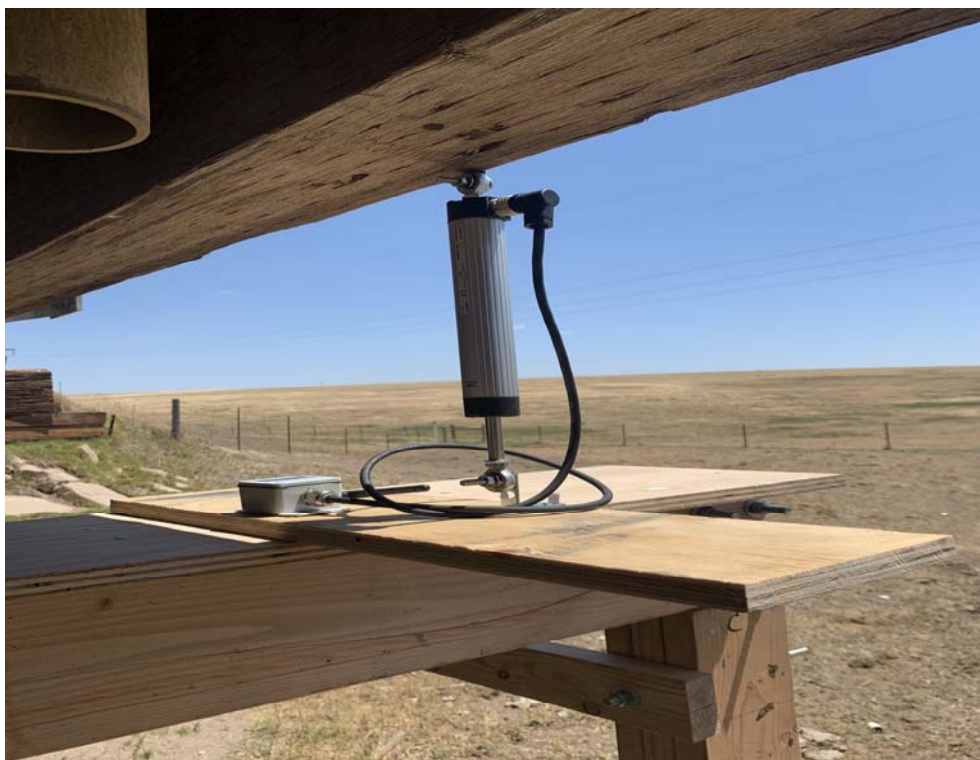
Слика 1.11. Постављање угиба, неопходан контакт са структуром (директан контакт) и чврста подлога испод разматране структуре
