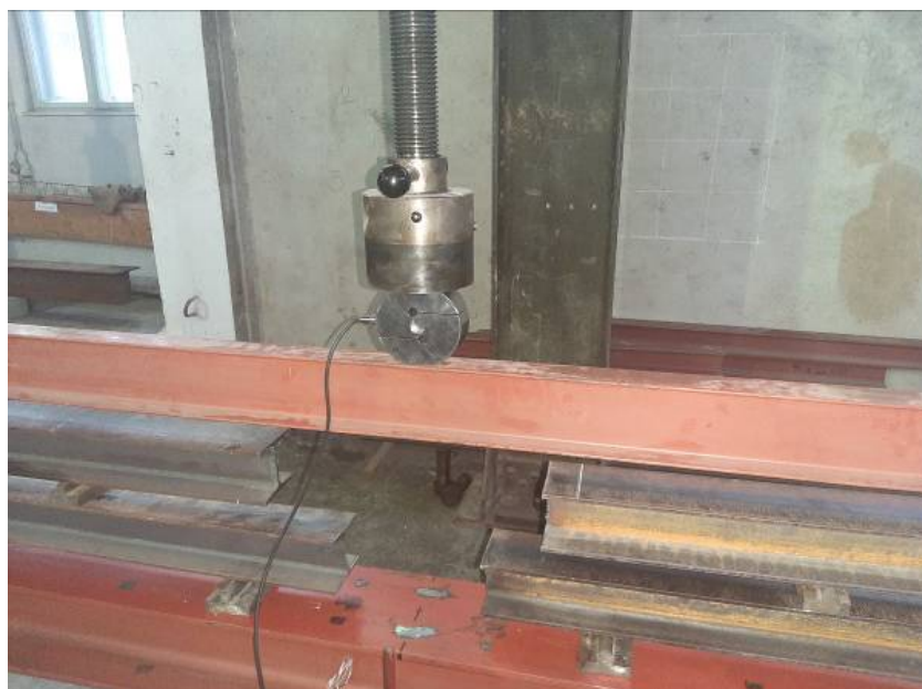
Слика 4.6. Динамометар TS 10 АЕР за мерење величине аплициране силе
