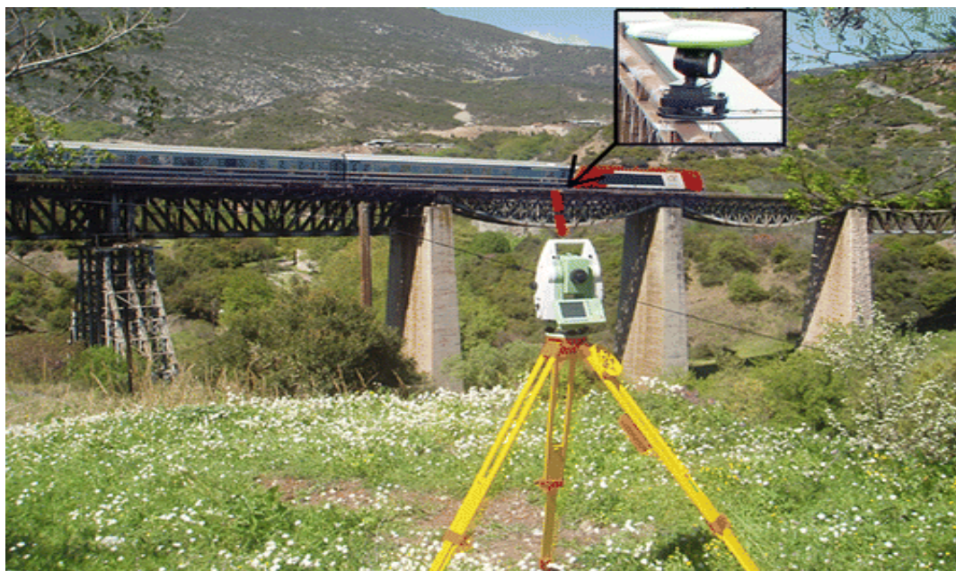
Слика 1.14. Мерење угиба структуре моста помоћу тоталне станице и геодетске призме постављене на мосту
