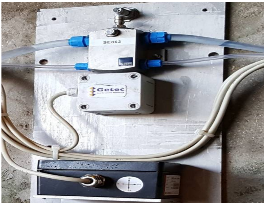
Слика 2.10. Мензура за електронско читавање HLS система
