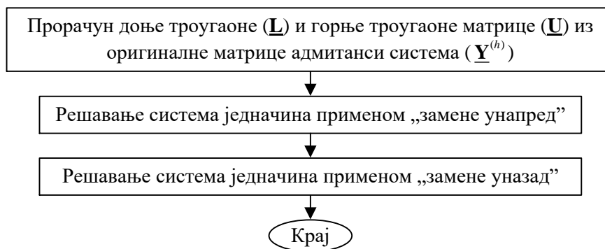
Слика 4.5 Алгоритам решавања система линеарних алгебарских једначина применом LU декомпозиције
