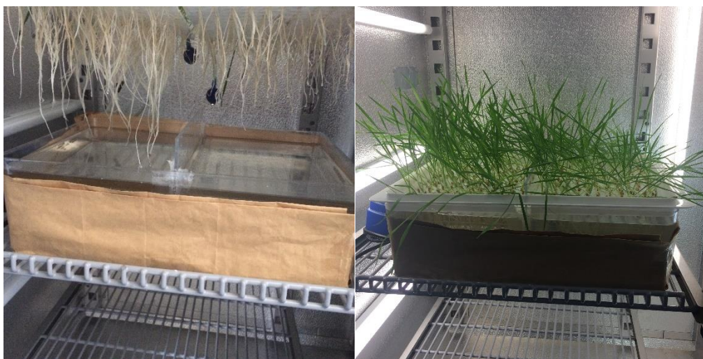
Slika 6. Rast klijanaca u fitotronu (leva polovina kutije – kontrola; desna polovina – tretman PEG 6000-om)
