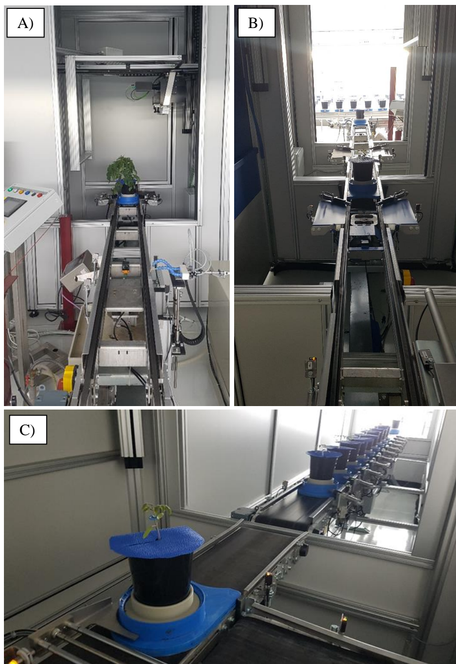
Slika 16. Komora sa RGB kamerom i jedinica za zalivanje i merenje mase biljaka (A), komora sa hiperspektralnom kamerom (B), komora za snimanje fluorescencije hlorofila i tunel za adaptaciju biljaka (C).
