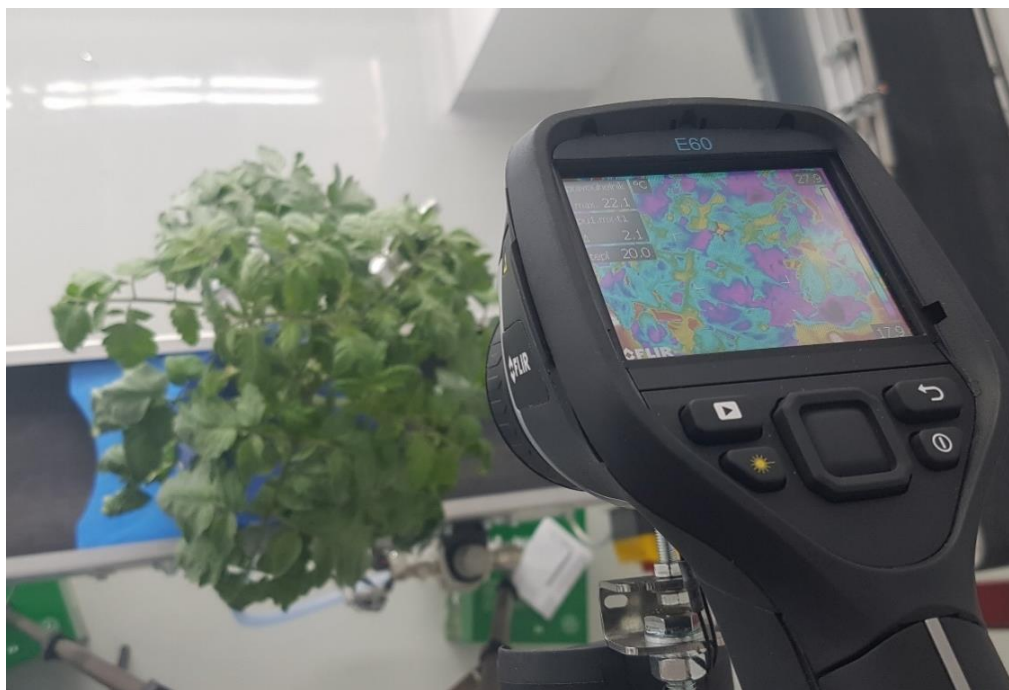
Slika 17. Snimanje biljaka pomoću termalne kamere FLIR E60 (FLIR Systems, Inc., Wilsonville, Oregon, SAD).
