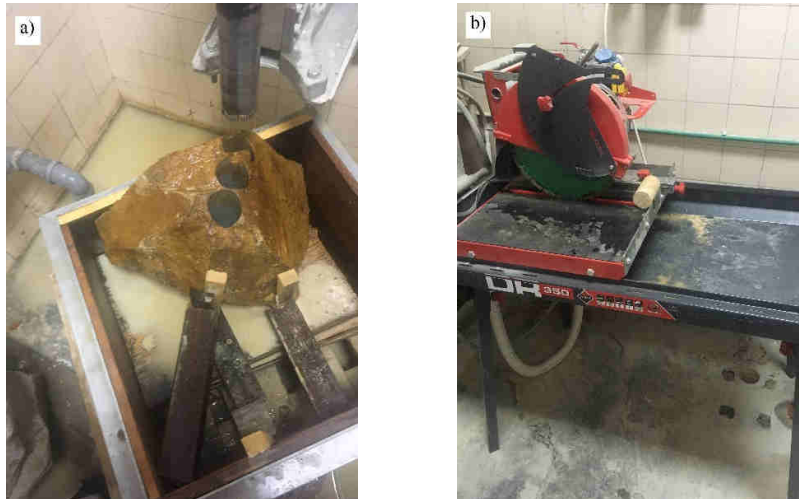
Слика 16. Поступак припреме пробних тела за лабораторијска испитивања: а) бушење блокова, б) сечење језгра
