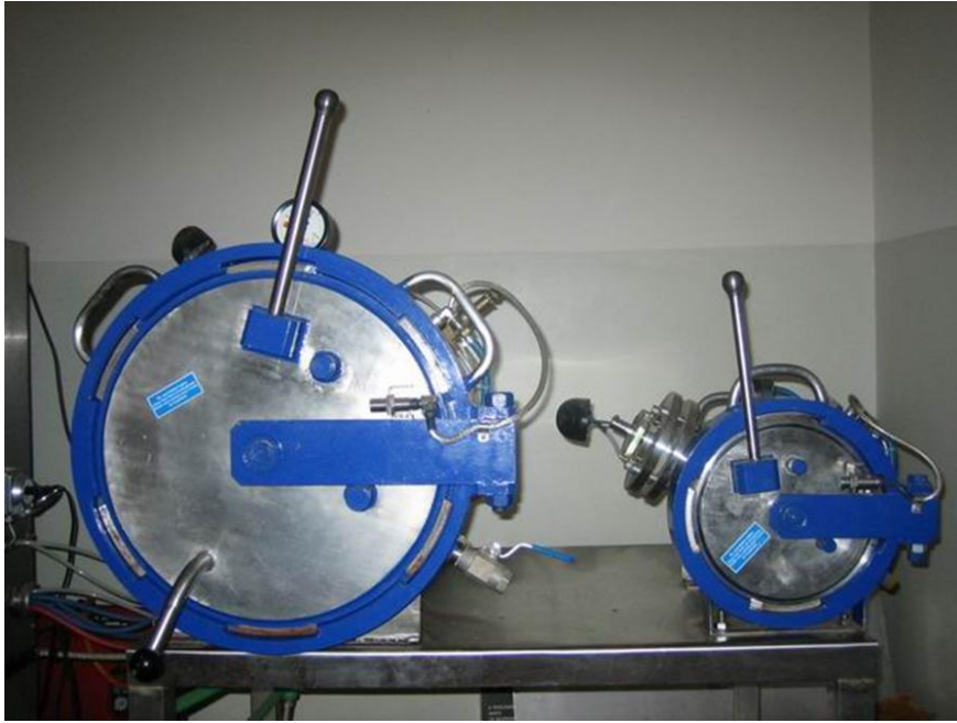
Slika 7. Komora za hiperbaričnu oksigenaciju posebno prilagođena za rad sa eksperimentalnim životinjama ( Holywell Neopren , Beograd, Srbija)
