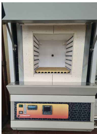
Slika 3. Peć za sintezu.
