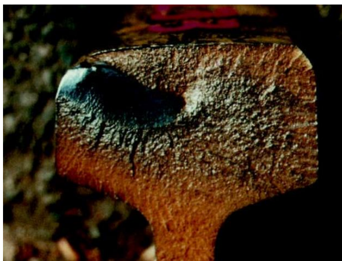
Слика 3.4 Попречни лом услед НС дефекта [13]
