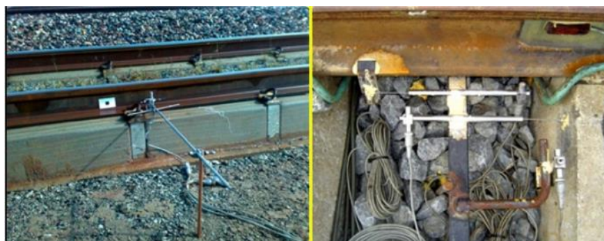
Слика 5.14 Диференцијални индуктивни трансформаторски претварач (LVDT) [198]
