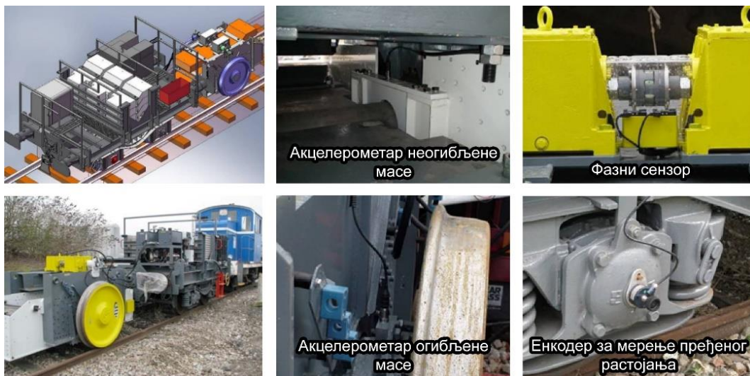
Слика 5.25 Шематски приказ Portansemetre возила и поставка возила за извођење мерења на терену (лево), поставка сензора мерног система возила (десно) [190]
