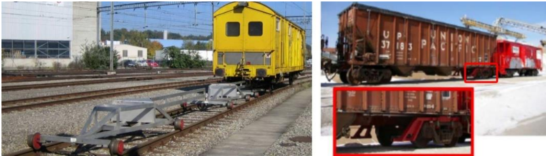
Слика 5.19 SBB возило за мерење крутости колосека (лево) [184, 189] и поставка UNL мерног система на возило (десно) [184]
