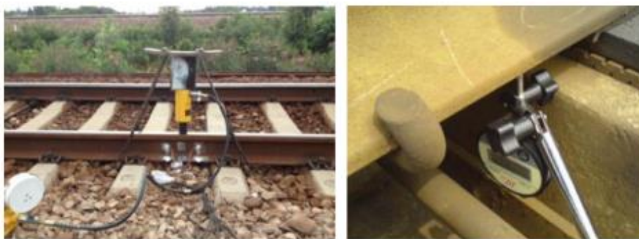
Слика 5.10 Хидраулички клип за наношење оптерећења и мерач угиба [184]
