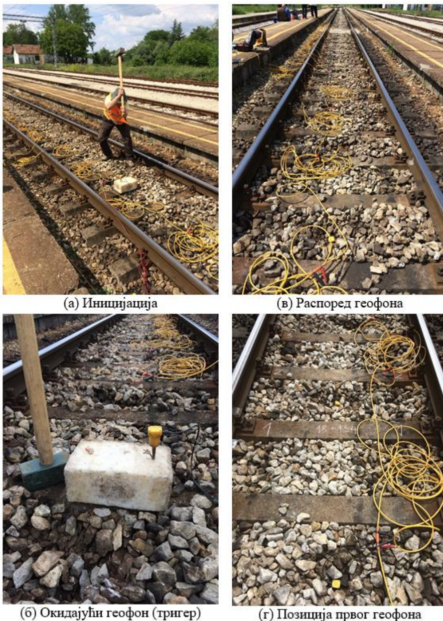
Слика 6.43 Детаљи примене сеизмометрије на колосеку број 2
