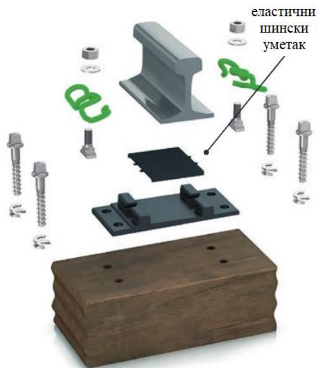
Слика 5.3 Еластични шински уметак у оквиру система шинског причвршћења
