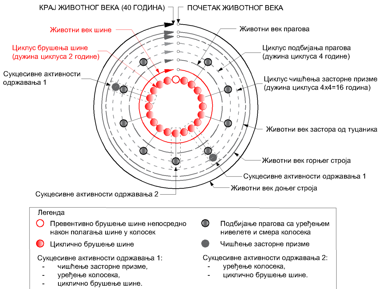
Слика 2.13 Принцип интегралног одржавања конструкције горњег и доњег строја са једнаким животним веком шине и прага
