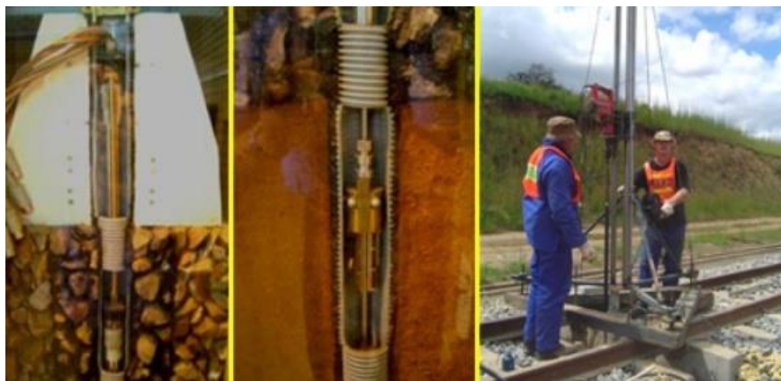
Слика 5.13 Уређај за истовремено мерење угиба на више дубина [198]
