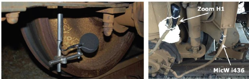
Слика 4.13 Поставка микрофона за индиректно мерење нивоа буке (лево) [126] и система микрофона постављених на последње обртно постоље возила (десно) [128]
