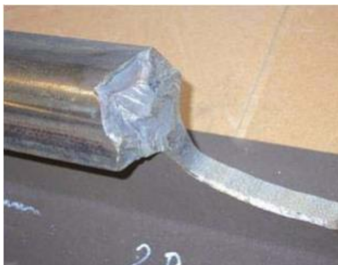
Слика 3.10 Пример попречног лома шине услед squat дефекта [16]
