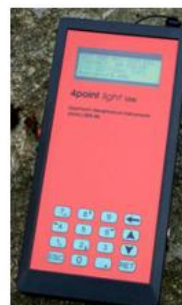
Мерни инструмент 4-point light HP resistivity meter (десно) са екстерним напајањем (лево)
