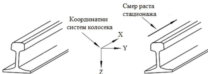
Слика 6.20 Положај оса релативног просторног правоуглог десног координатног система XYZ у колосеку
