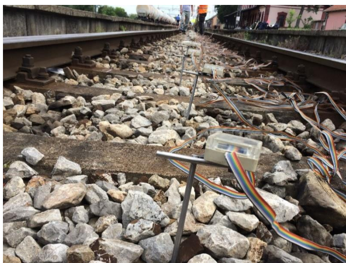
Слика 6.25 Положај електрода за електрометријско скенирање профила ES-2 (средњи профил у оси колосека)
