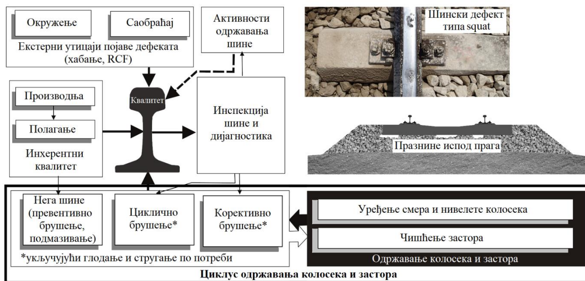
Слика 2.11 Укључивање технике брушења у циклус одржавања колосека и застора
