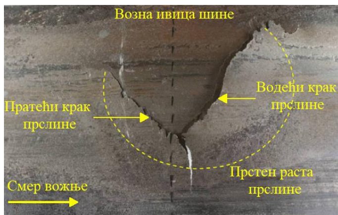
Слика 3.9 Водећи и пратећи крак „V“ прслине након лабораторијског третмана савијања у вертикалној равни [58]
