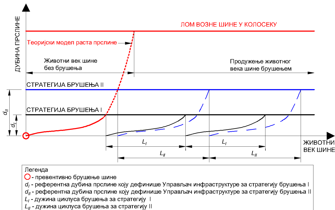
Слика 2.15 Принцип утицаја цикличног брушења на животног век шине
