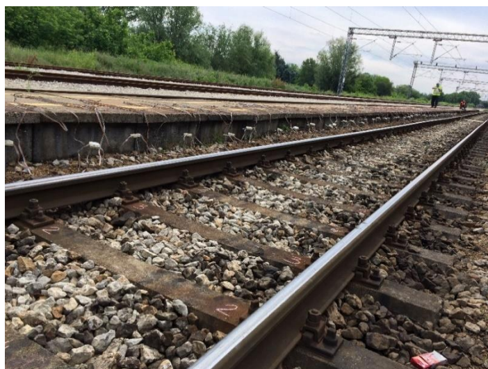
Слика 6.24 Положај електрода за електрометријско скенирање профила ES-1 (леви профил)
