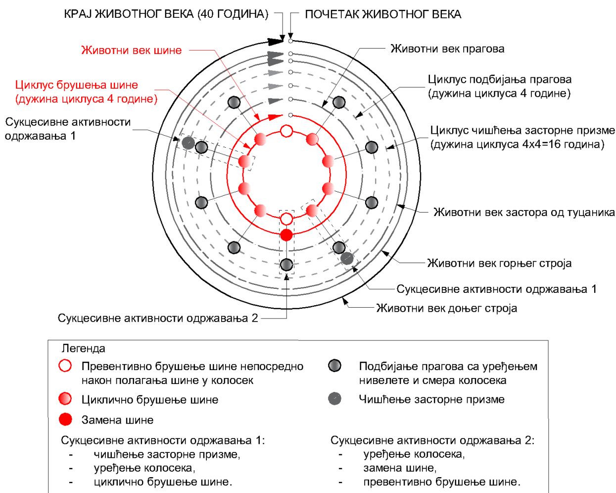
Слика 2.12 Принцип интегралног одржавања конструкције горњег и доњег строја са заменом шине на половини животног века конструкције
