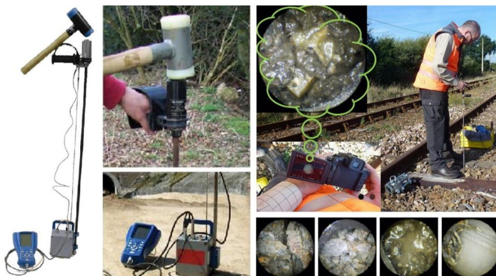
Слика 5.12 PANDA уређај [195] и идентификација слојева помоћу ендоскопије [196]
