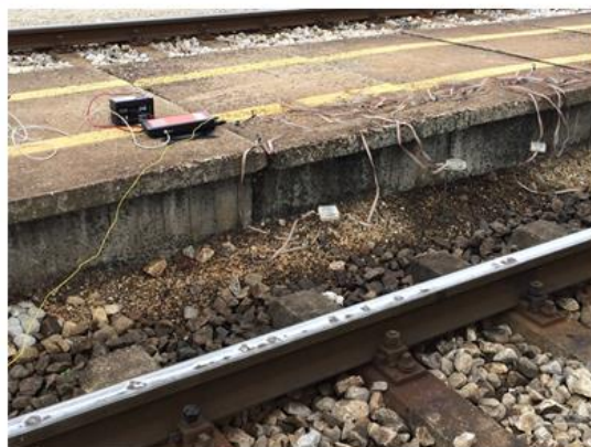
Слика 6.21 Мерни систем примењен за мултиелектродно електрометријско скенирање на колосеку 2
