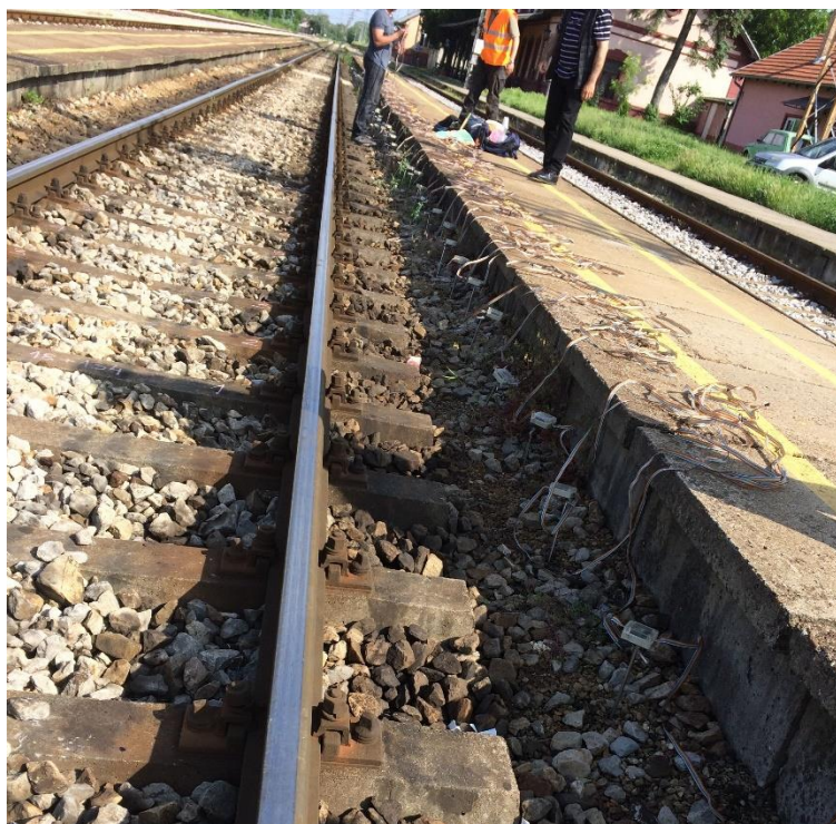
Слика 6.26 Положај електрода за електрометријско скенирање профила ES-3 (десни профил)
