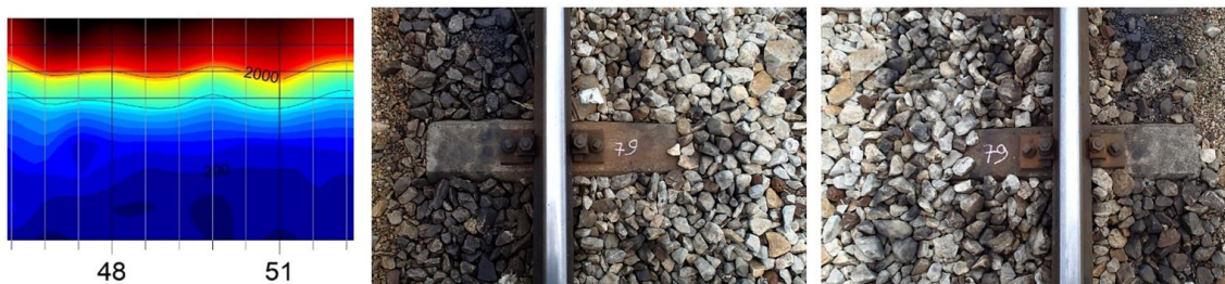
Слика 6.35 Део електрометријског профила ES-2 (лево) и појава заобљених зрна туцаника на средњем делу прага број 79
