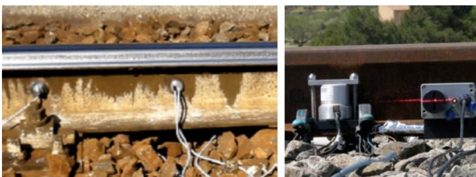
Слика 5.15 МРQУ сензор (лево) [199] и геофон и пријемник ласерског зрака причвршћени за ножицу шине (десно) [187]
