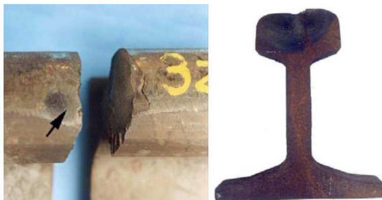
Слика 2.17 Један од суцесивних шинских ломова у Hatfield–у услед замора шинског челика [10]
