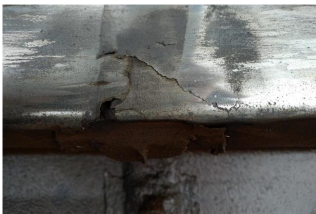
Слика 3.26 Обострано појављивање squat дефекта у односу на алуминотермијски завар (колосек број 2 у станици Панчево Варош, октобар 2020. године)
