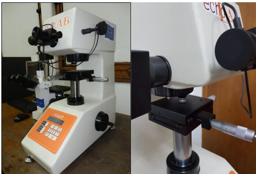
Slika 3.10. Uređaj za merenje mikrotvrdoće EchoLAB tipa HTV 100
