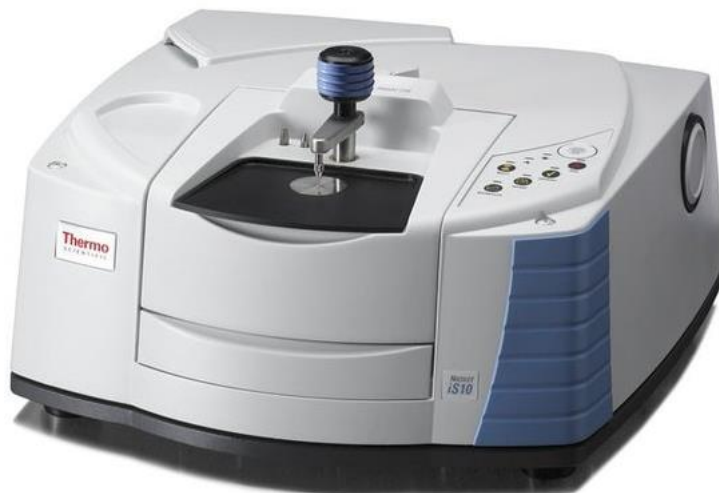
Slika 3.11. Spektrofotometar za merenje stepena konverzije tipa Nicolet iS™10 FT-IR sa ATR dodatkom
