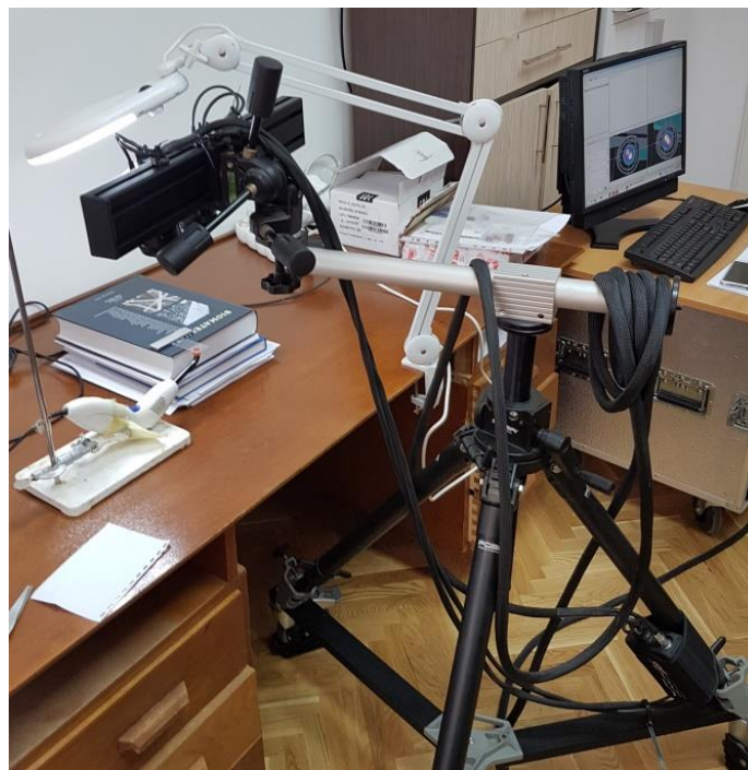
Slika 3.9. a) Oprema za merenje 3D-DIC metodom (programski paket Aramis, senzorska jedinica, postolje, kompjuter, svetla i trigger kutija), b) Ispitivanje kompozitnog cementa 3D-DIC metodom tokom svetlosne polimerizacije LED lampom
