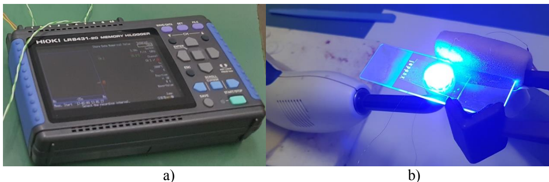
Slika 3.15. a) Višekanalni logger podataka tipa HIOKI LR8431-20, b) Merenje porasta temperature tokom svetlosne polimerizacije dentalnih cemenata primenom termoparova
