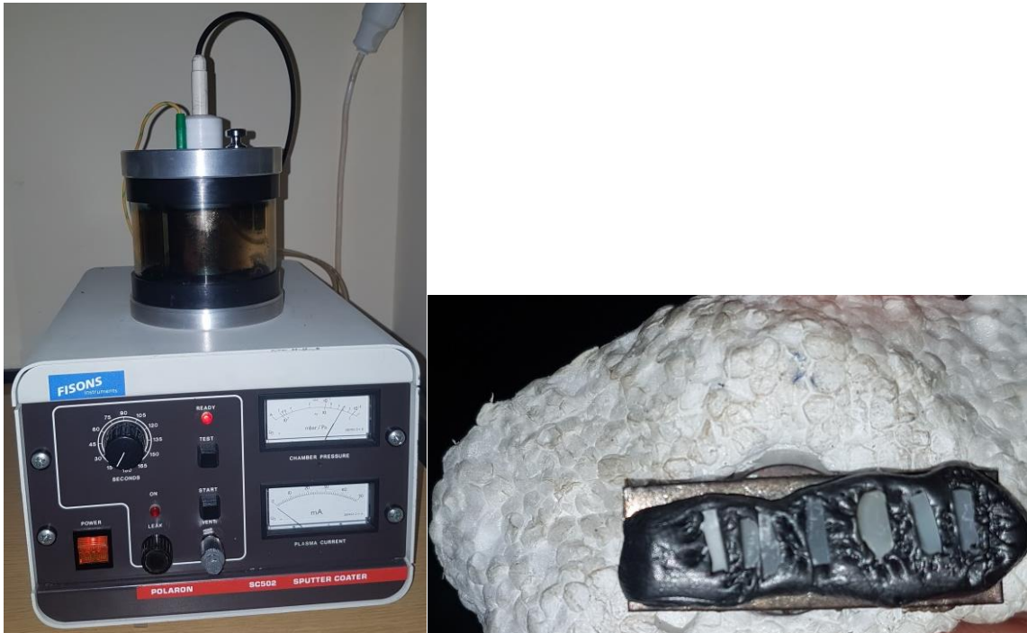
Slika 3.12. Uređaj za vakuum naparavanje tipa Polarion SC502 Sputter Coater
