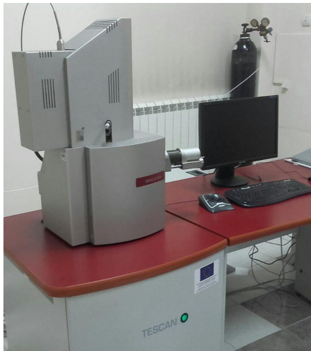
Slika 3.13. Skenirajući elektronski mikroskop tipa Tescan Mira 3XMU
