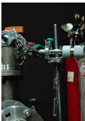
Slika 2.9 Epruveta sa uzorkom i ventil za kontrolu pritiska – levo, epruveta i traka za odgrevanje sistema – desno.
