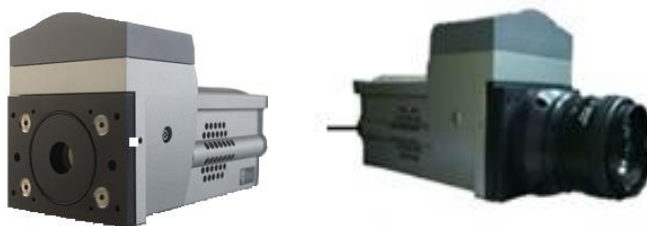
Slika 2.7 ICCD kamera Andor, iStar DH720-18U-03 (levo) i kamera sa montiranim objektivom Nikkor Lens 50 mm f/1.4D (desno).
