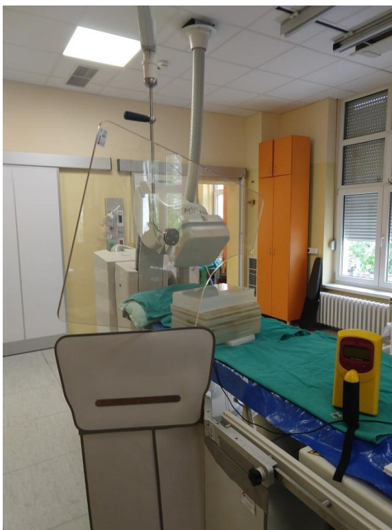
Слика 6.6 – Мерења јачине амбијенталног дозног еквивалента за потребе валидације Монте Карло симулација
