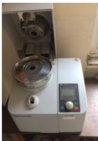
Slika 33. Vibracioni mlin sa prstenastim radnim elementima "Siebtechnik-TS250"
