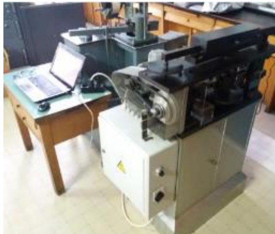
Slika 83. Fotografija opreme za tribološka ispitivanja
