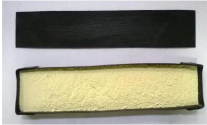
Slika 32. "Lađica" sa mešavinom polaznih prahova \text{WO}_3 , S i \text{K}_2\text{CO}_3
