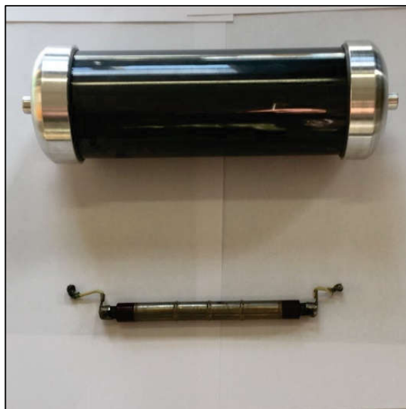
Слика 6.1 Модел ГМ бројачке цеви (горе) и комерцијална ГМ цев (доле)
