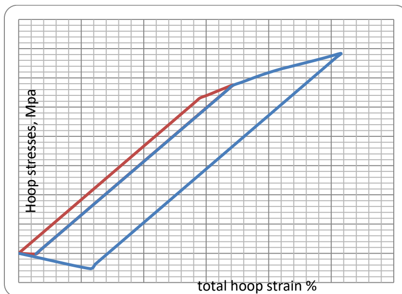
Slika 48 Dijagram zavisnosti obimnog napona deformacije za zavareni spoj WM LS1 SAW
