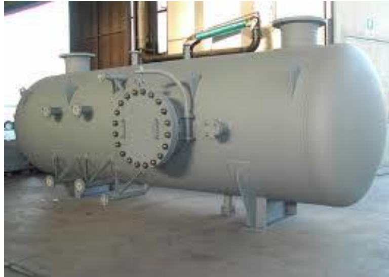
Slika 3 Horizontalni cilindrični skladišni rezervoar
