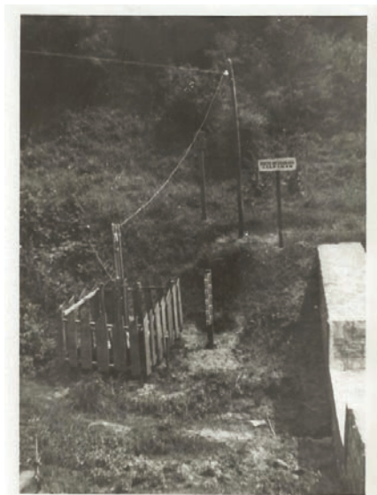
Слика 9. Наша прва проучавања отицања бујичних поплавних вода са електромагнетским преносом података на даљину, без обзира да ли се јака киша јавља по дану или ноћи. Огледни слив „Рипе“, 1954 г.
