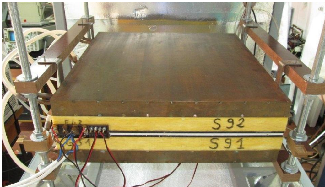
Слика 6.1.1. Узорци стандардног референтног материјала постављени за мерење у првој валидацији.
