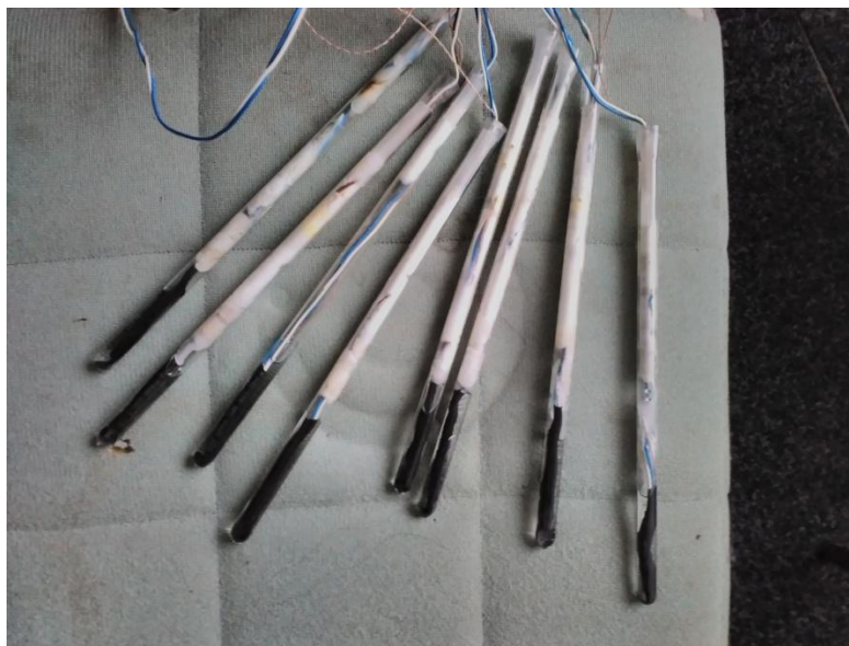
Слика 4.2.3. Решење за хладни крај термопара.
