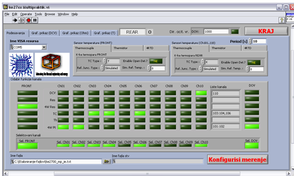
Слика А.3.1. Изглед прозора главног виртуелног инструмента за аквизицију вредности температуре – страна за активирање улаза и опцијама мерења
