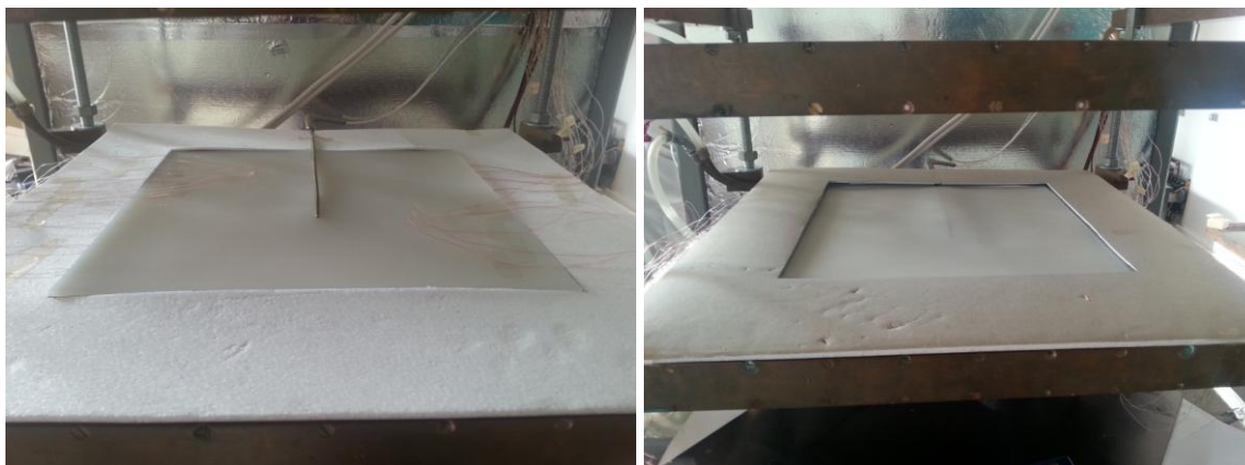
Слика Б.1.1. Постављање термопарова за еталонирање у апаратури.
