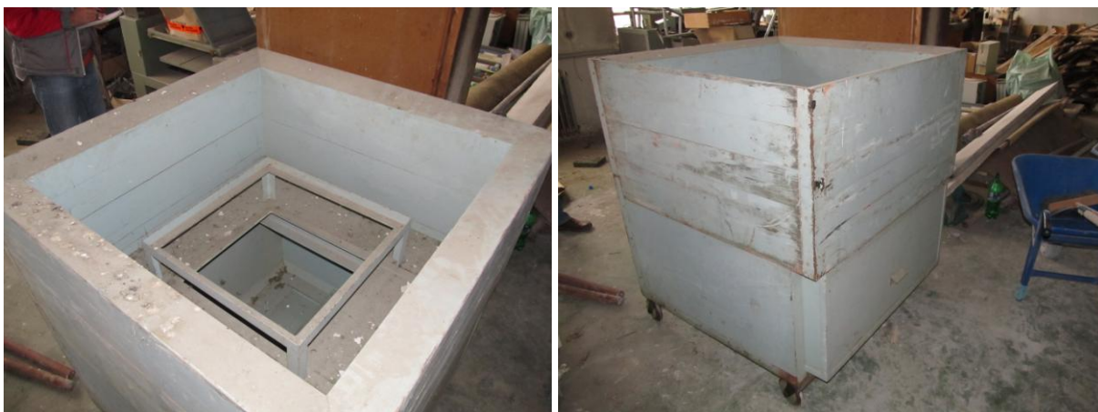
Слика 4.1.1. Фотографије првобитне изолационе коморе са носећом конструкцијом.
