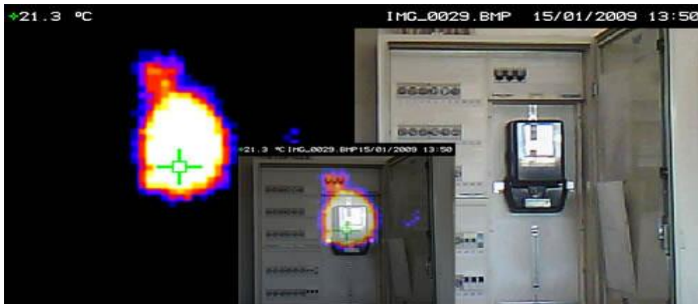
Слика 13. Снимак инструмента за термовизијску дијагностику у ГРО (Јанковић, 1999).
