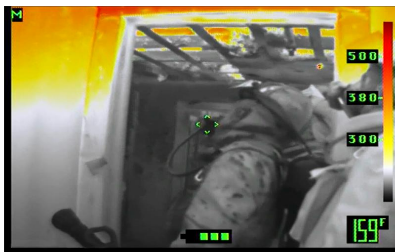
Слика 14. Снимак инструмента за термовизијску дијагностику у пожару (Барбарић, 2012:123).
