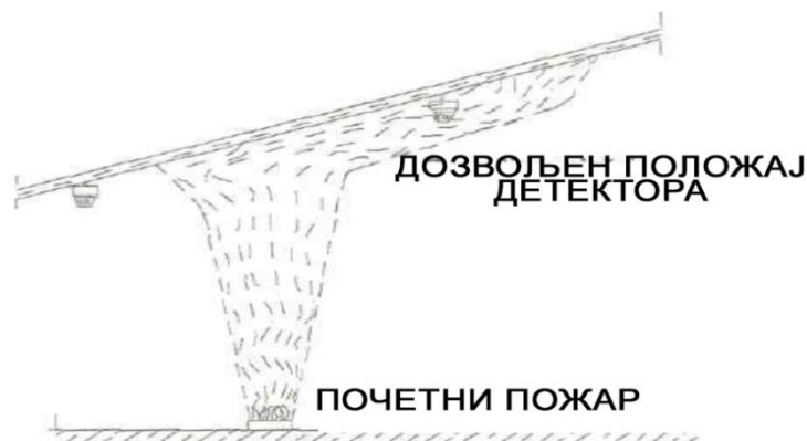
Слика 7. Изглед стабла пожара код кривих плафон (Капор et al., 2000:39).
