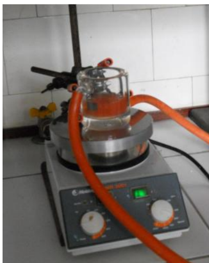
Слика 3.4. Изглед ћелије за фотокаталитичке експерименте.
