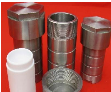
Слика 3.1. Слика аутоклава коришћеног у хидротермалној синтези.
