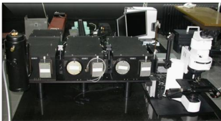
Слика 3.2. Микро - Раман уређај TriVista TR557.
