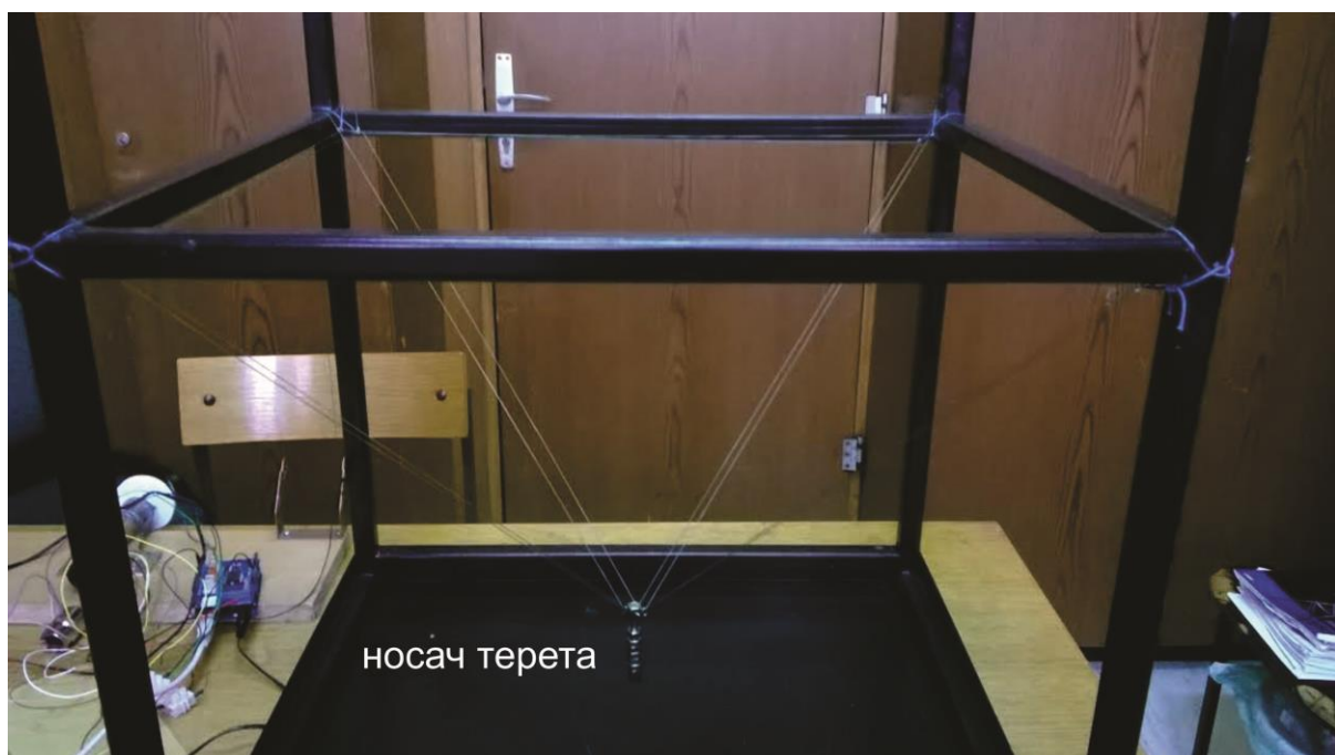
Слика 6.7 – Позиција носача терета означена као I.
