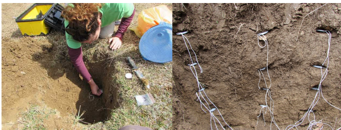
Slike 5.39. i 5.40. Postavljanje pločica u zemlju na karstnom terenu
