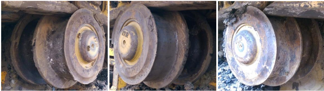
Слика 4.14. Горњи точкови дозера TD25M на површинским коповима Дрмно, Тамнава Запад и Велики Црљени, након 1205, 1880 и 2242 сати рада, респективно
