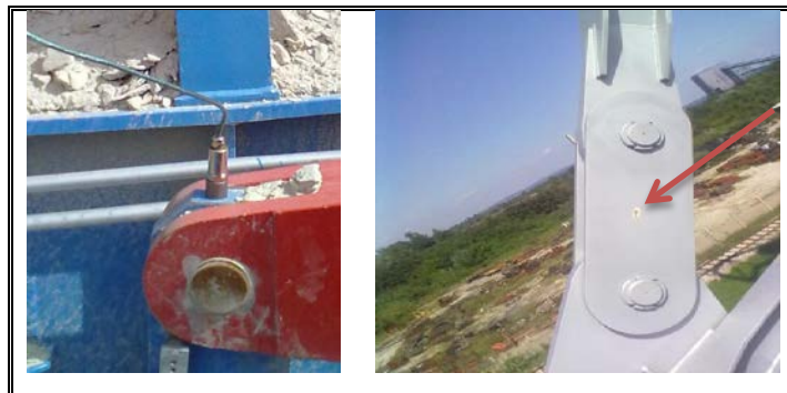
Slika 7.2. – Položaj mernih traka na bageru
