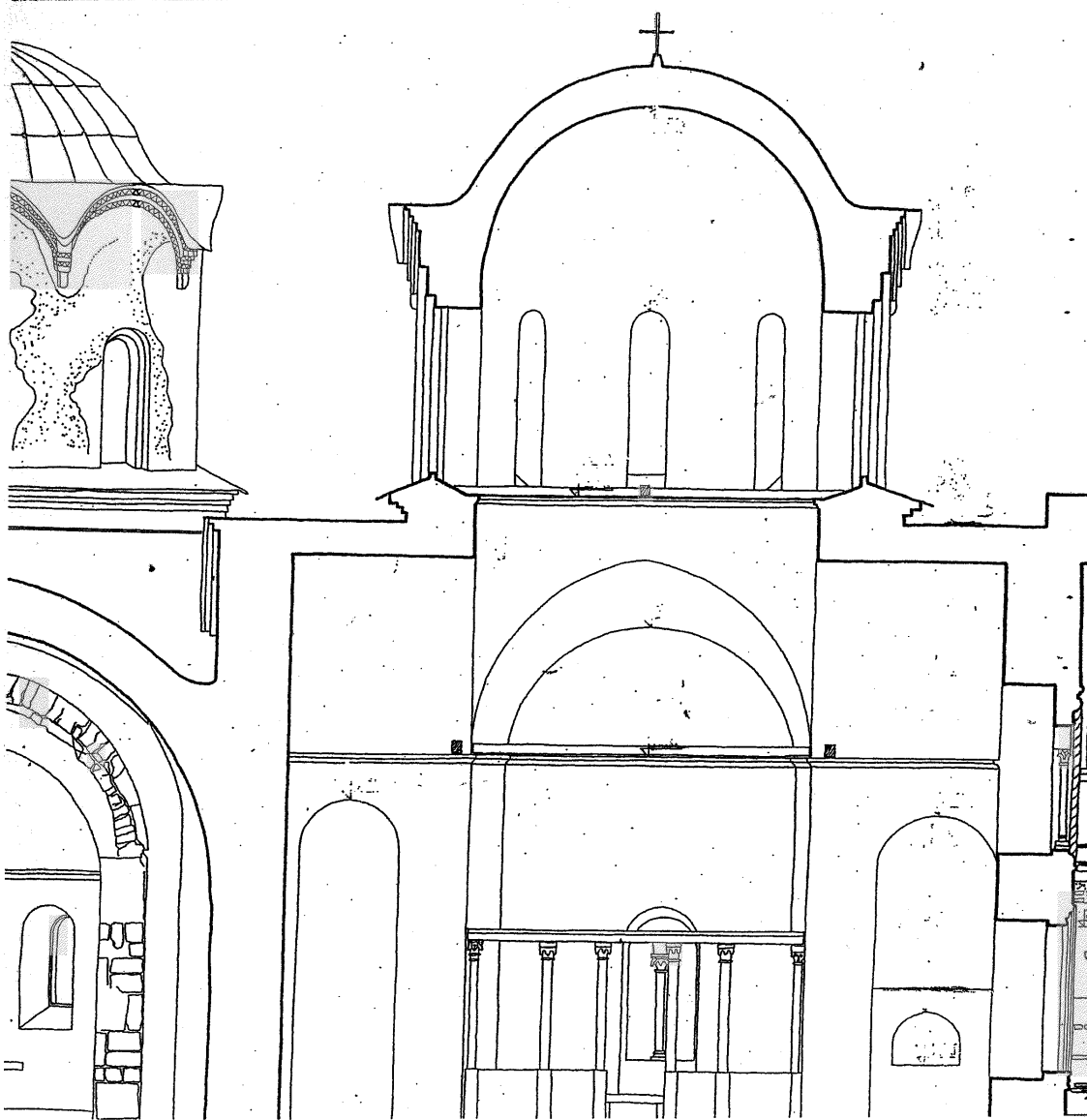
Попречни пресек кроз куполни простор Богородичине цркве с погледом на источну страну
