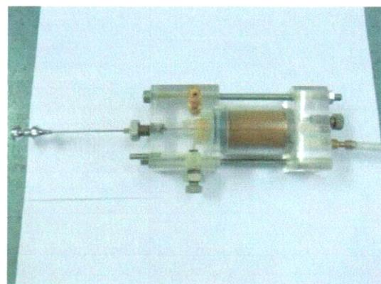
Slika 5.16. Izgled ugrađenog uzorkom sa pripremljenom iglom za formiranje pore
