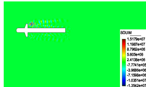
Слика 6.38: Поље акустичних извора дбијени LES-Смагоринским методом
