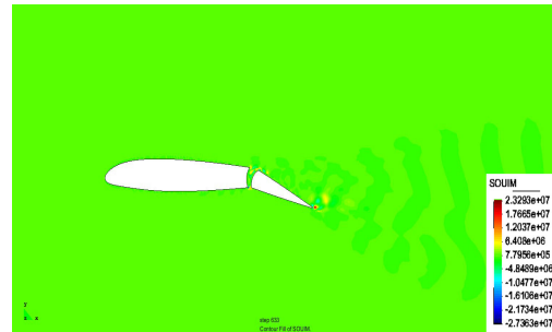
Слика 6.219: Имагинарно поље акустичних извора око аеропрофила LES-Смагорински
