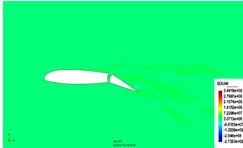
Слика 6.252: Имагинарно поље акустичних извора око аеропрофила добијени OSGS
