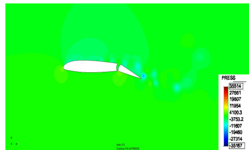
Слика 6.235: Поље притиска око аеропрофила после 0.2 секунде добијени ортогоналном SGS методом са динамичким праћењем малих величина
