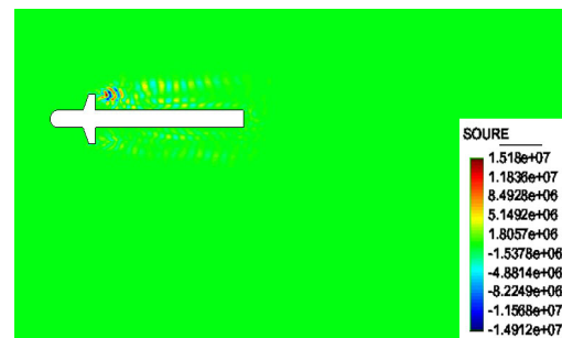
Слика 6.40: Поље акустичних извора дбијени LES-Смагоринским методом
