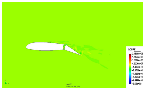
Слика 6.254: Реално поље акустичних извора око аеропрофила добијени OSGS
