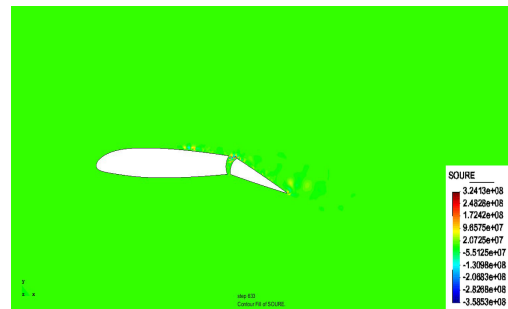
Слика 6.255: Реално поље акустичних извора око аеропрофила добијени OSGS
