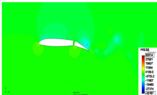
Слика 6.236: Поље притиска око аеропрофила после 0.25 секунде добијени ортогоналном SGS методом са динамичким праћењем малих величина
