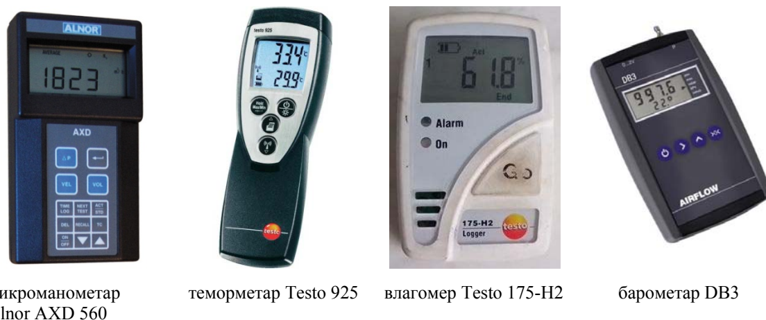
Слика 5.4 Мерни уређаји за мерење протока ваздуха
