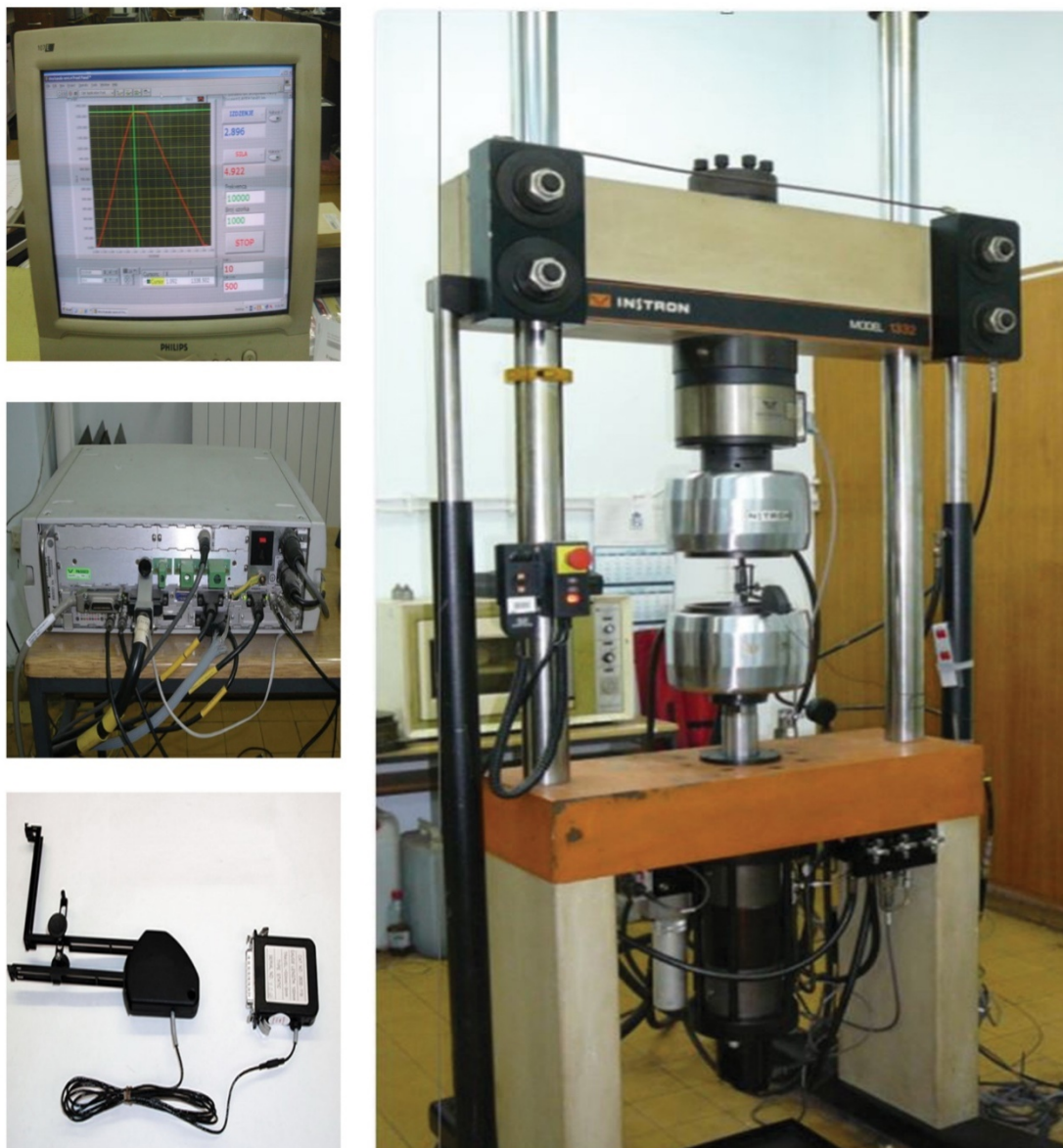
Слика 3.1 Лабораторија са опремом за испитивање карактеристика PLA материјала (Технолошко-металуршки факултет Београд)
