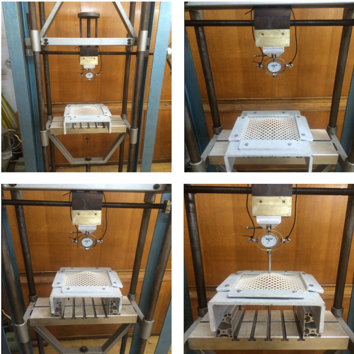
Слика 3.21 Извођење конвенционалног експеримента оптерећења и мерење деформације гредног роштиља
