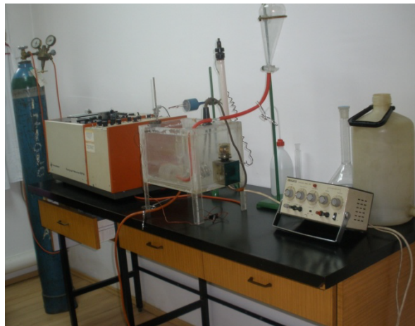
Slika 8. Oprema za registrovanje kontrakcija izolovanog creva pacova u laboratoriji za gastrointestinalnu fiziologiju Instituta za medicinsku fiziologiju
