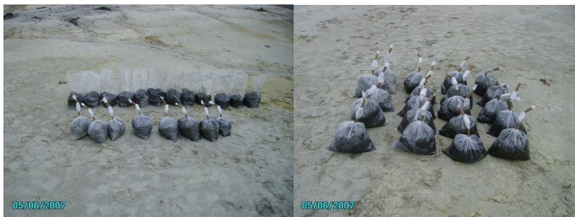
Slika 13. Priprema i pakovanje uzoraka flotacijske jalovine iz jezgara bušotina
