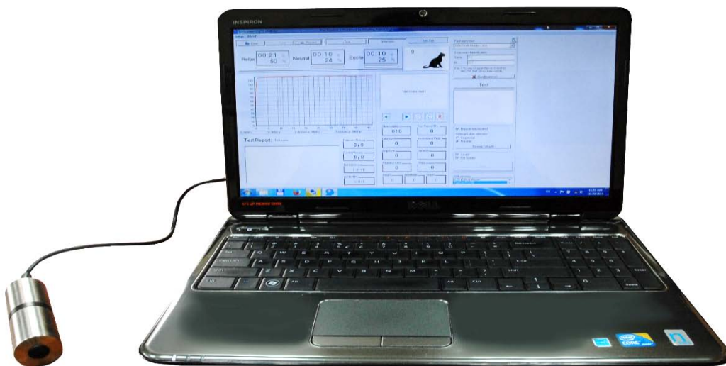
Слика 24: Рачунар са софтвером LieScanner LS351 за мерење емоционалне реактивности Методом адаптивне стимулације и припадајућим мерачем ЕДА.
