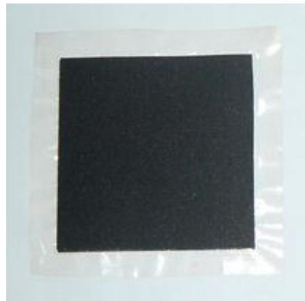
Slika 19. Izgled membransko-elektrodnog sklopa, MEA
