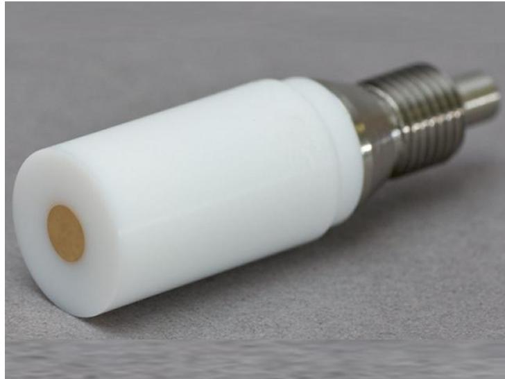
Slika 24. Tipični izgled RDE sa Au vrhom
