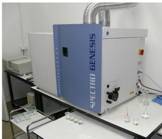
Slika 3.10. Instrument sa induktivno spregnutom plazmom - optičko emisionom spektrometrijom (ICP-OES, Spectro Genesis EOP II, Spectro Analytical Instruments GmbH, Kleve, Germany).
