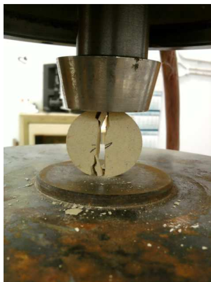
Слика 43. Приказ лома узорка при одређивању затезне чврстоће узорака
