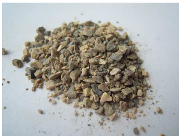
Слика 29. Изглед боксита који је коришћен у раду
