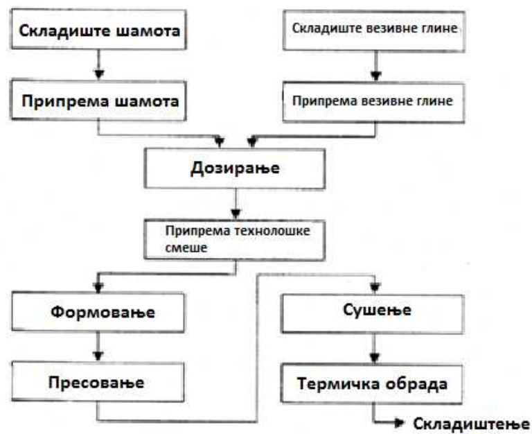
Слика 3. Технолошка шема производње шамотних и полукиселих ватросталних материјала [3]
