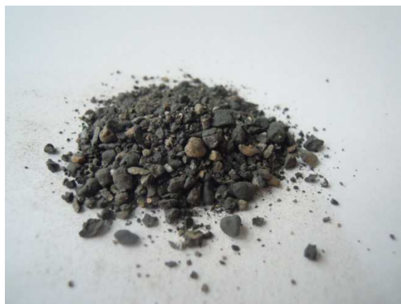
Слика 31. Изглед шамота који је коришћен у раду
