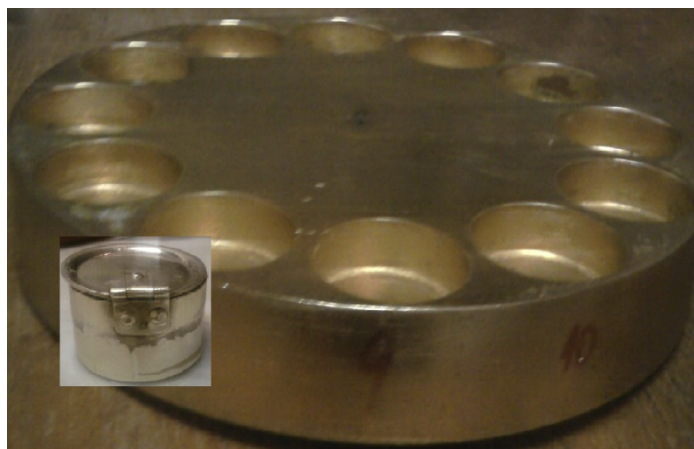
Slika 12. Pozlaćen bakarni blok i pozlaćene posude od srebra.
